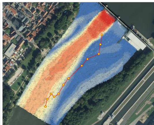
Bild 4: Beispiel zweier Durchfluss-Szenarien, unter dem jeweils gleichen Fishtrack (hinterlegtes Foto: DLZ des Bundes für Geoinformation und Geodäsie)
