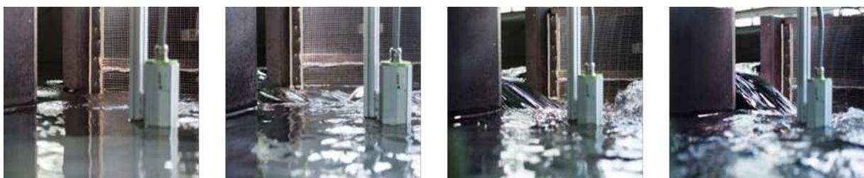
*Bild 2: Schlitzströmung bei Szenario 0,8 m/s (links), 1,2 m/s (Mitte links), 1,5 m/s (Mitte rechts) und 1,8 m/s (rechts) im modellierten Einstiegsschlitz des ethohydraulischen Versuches zur Passierbarkeit von FAA-Einstiegen bei verschiedenen Bemessungsgeschwindigkeiten (© BAW/BfG)*
