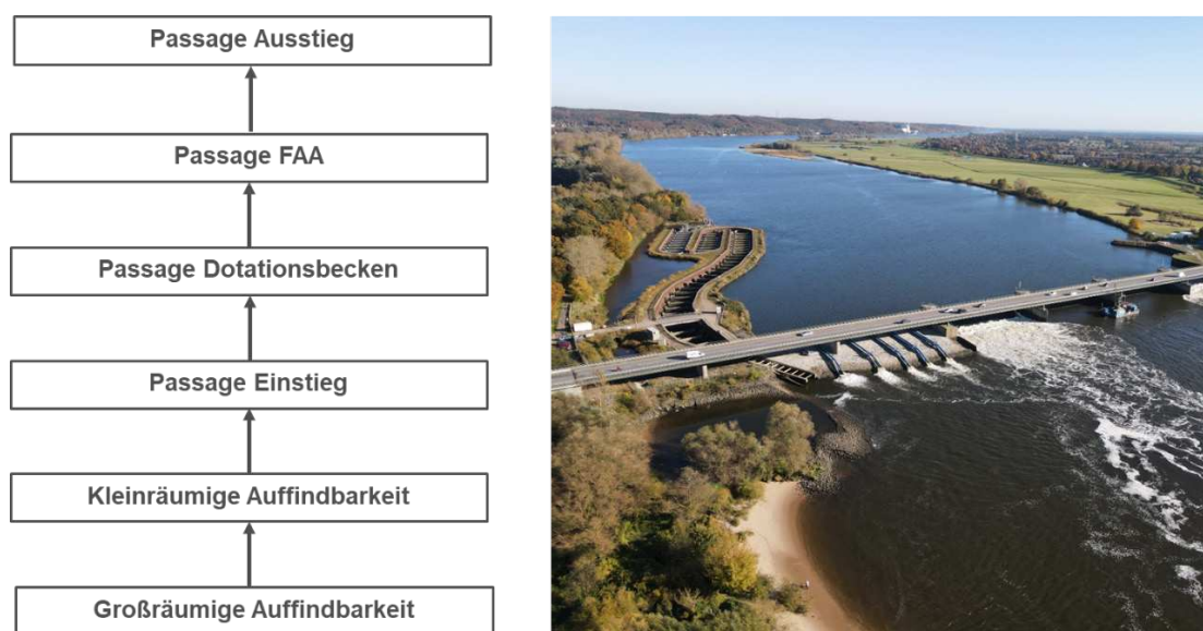
Bild 1: Einzelaufgaben im Rahmen eines Fischaufstiegs (Foto: Wehr Geesthacht an der Elbe, Stefan Lühr)
