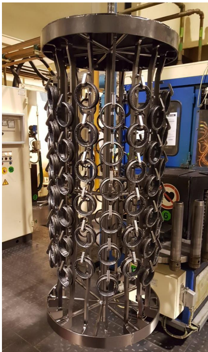
Abbildung 4-27: Schaltmuffen auf dem Gestell zum Reinigungs-/Verfestigungsstrahlen
