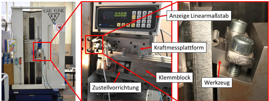
Abbildung 4-9: Elektrische Räummaschine (links), Werkzeug-Zustellvorrichtung (Mitte), Werkzeugaufnahme mit WSP und Probe aus weichgeglühtem 16MnCr5 (rechts)
