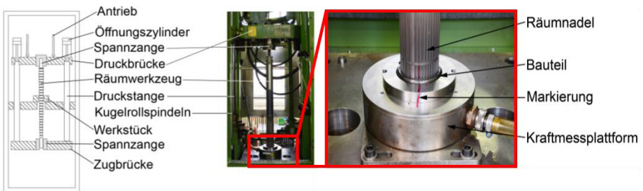
Abbildung 4-7: Schematische Darstellung Räummaschine (links, (Tönshoff & Denkena, 2011)) und Abbildung der Versuchsmaschine am wbk, Kraftmessplattform und Bauteilaufnahme in der Räummaschine (rechts)
