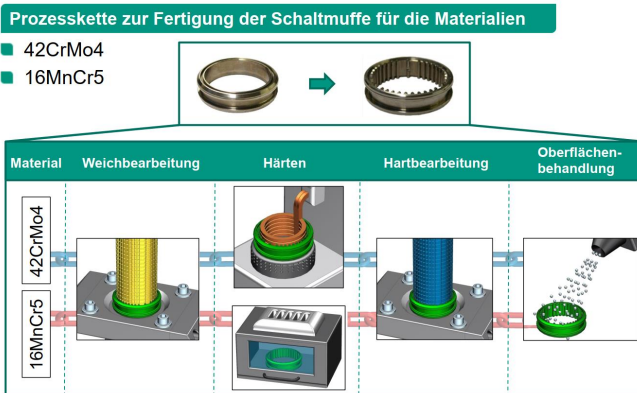
Abbildung 3-2: Prozessschritte Herstellung Schaltmuffe
