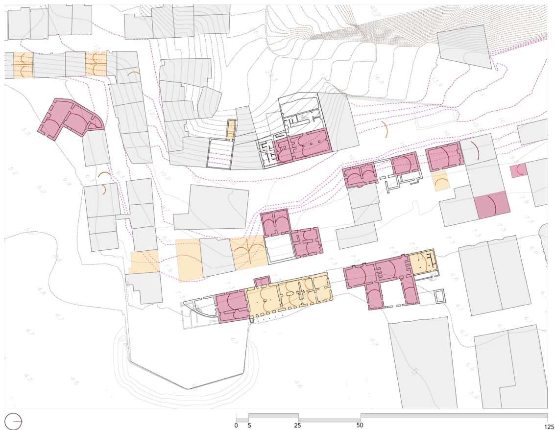
Figure 80. Plan des voûtes de Place Royale. En rose les voûtes existantes, en jaune : les voûtes démolies. Le pointillé en rose, illustre la topographie hypothétique, basée sur les coupes stratigraphiques des rapports d'archéologie consultés. Source : par l'auteur
