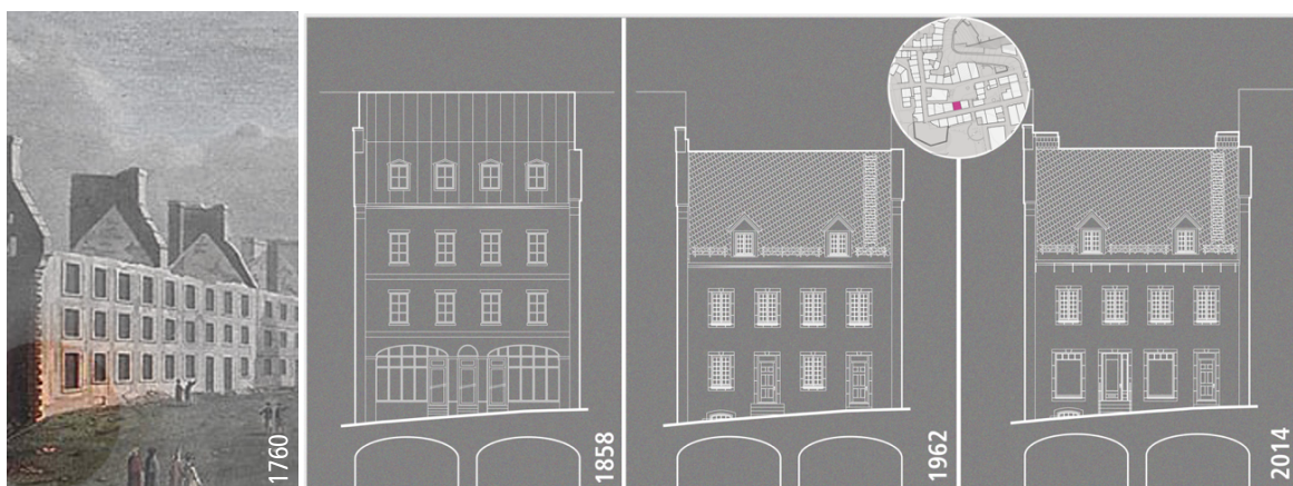
Figure 65. Extrait de la gravure de Short en 1760 et dessin des élévations de la maison Formel :1858, 1962, 2014 Source : Par Luíza Santos, à partir des plans d'archives.
