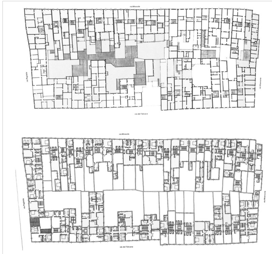
Figure 16. Plan d'un îlot dans le quartier Solferino, Bologne, avant (haut) et après (bas) restauration, par Pier Luigi Cervellati, vers 1969. Source: Image tirée de : Sonne (2017) Urbanity and Density in the 20th Century Urban Design . P.286.
