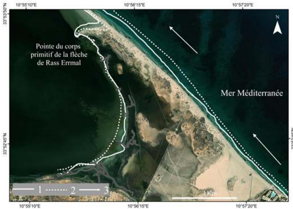
Figure 5 - L'évolution de la position du trait de côte et de la forme du corps primitif de la flèche de Rass Errmal, de 1963 à 1991. 1- trait de côte en 1991 ; 2- trait de côte en 1963 ; 3- dérive littorale (sources : photographies aériennes des missions de 1963 et 1991 ; réalisation : Z. Akacha).
