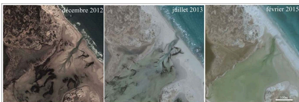
Figure 10 - Brèche ouverte au niveau de la racine de la flèche de Rass Errmal : témoin d'un stade avancé dans l'affaiblissement du corps sableux (sources : décembre 2012 : Image landsat 7 copernicus 2012 ; juillet 2013 : Image landsat 8 copernicus 2013 ; février 2015 : Image landsat 8 copernicus 2015).
