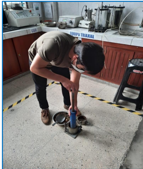
Anexo 13. Ensayo de Proctor modificado.
