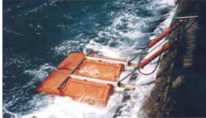
Figura 8. Dispositivo Undimotriz SDE.
