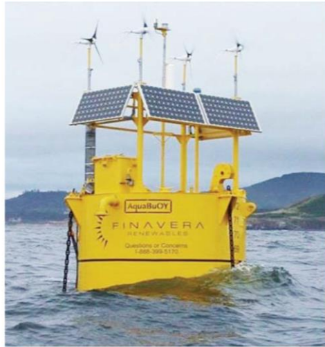
Figura 5. Dispositivo tipo Aquabuoy – Undimotriz
