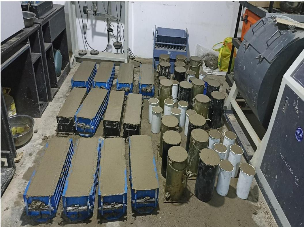
Fotografía 21: Briquetas y viguetas para la rotura de los 28 días (c° Patrón y experimental)
