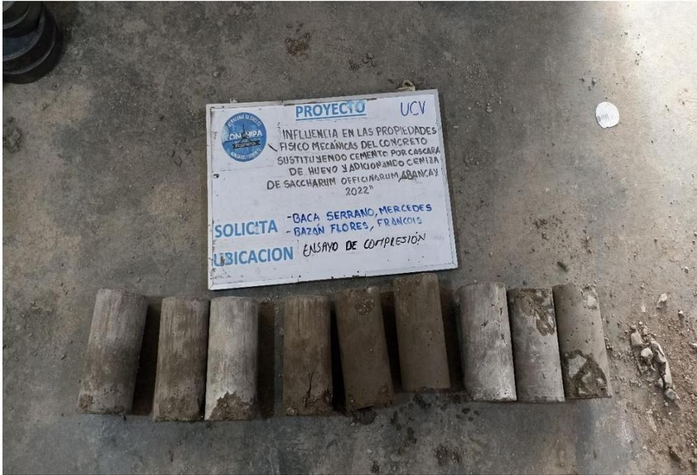
Fotografía 24: Ensayo de la resistencia a la tracción del concreto patrón y C° experimental
