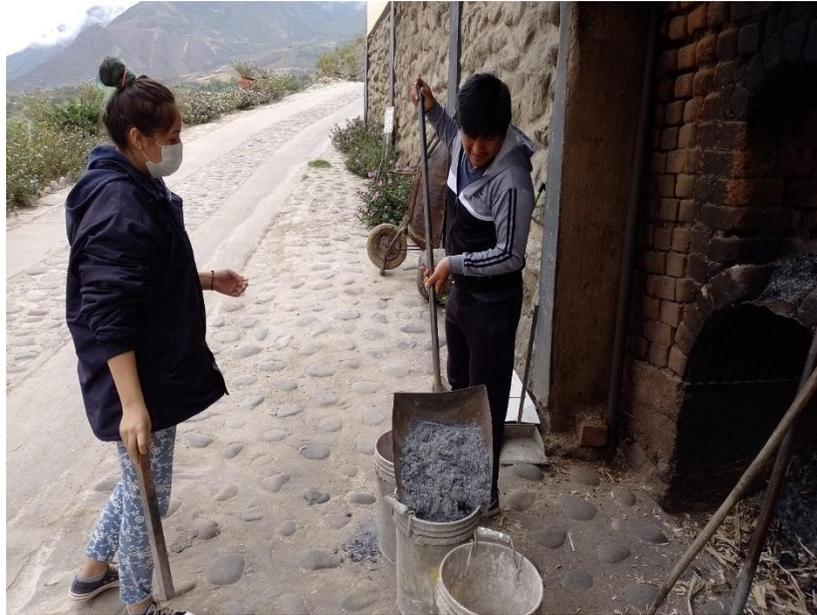
*Fotografía 2: Tamizado de la ceniza de bagazo de caña de azúcar por la malla N°200*
