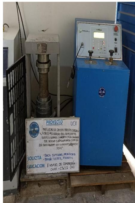
Fotografía 23: Ensayo de la resistencia a la compresión del concreto patrón y C° experimental
