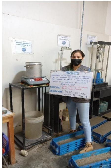
Fotografía 13: Ensayo del peso unitario del concreto experimental.
