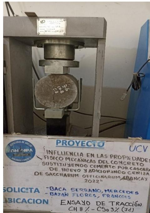
Fotografía 25: Ensayo de la resistencia a la tracción del concreto patrón y C° experimental.
