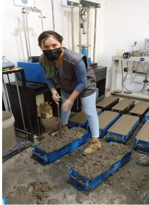
Fotografía 10: Ensayo de la consistencia o trabajabilidad del concreto patrón.
