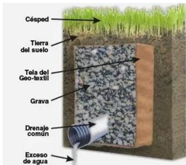
Ilustración 8: Detalle de Dren Filtrante
