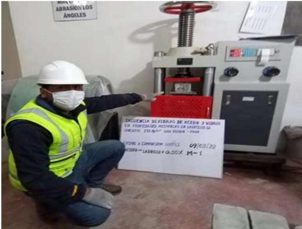
**Fotografía 41.** “Ensayo de compresión simple de las unidades de ladrillo a los 28 días”
