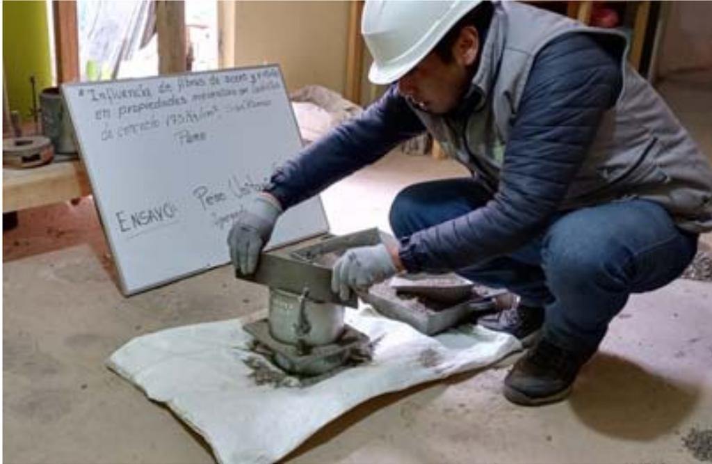
**Fotografía 15.** “Proceso de enrasado de la muestra de Agregado Fino en el molde para el ensayo de Peso unitario suelto del Agregado Fino”
