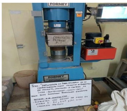
**Figura 3. Ensayo a la compresión**
