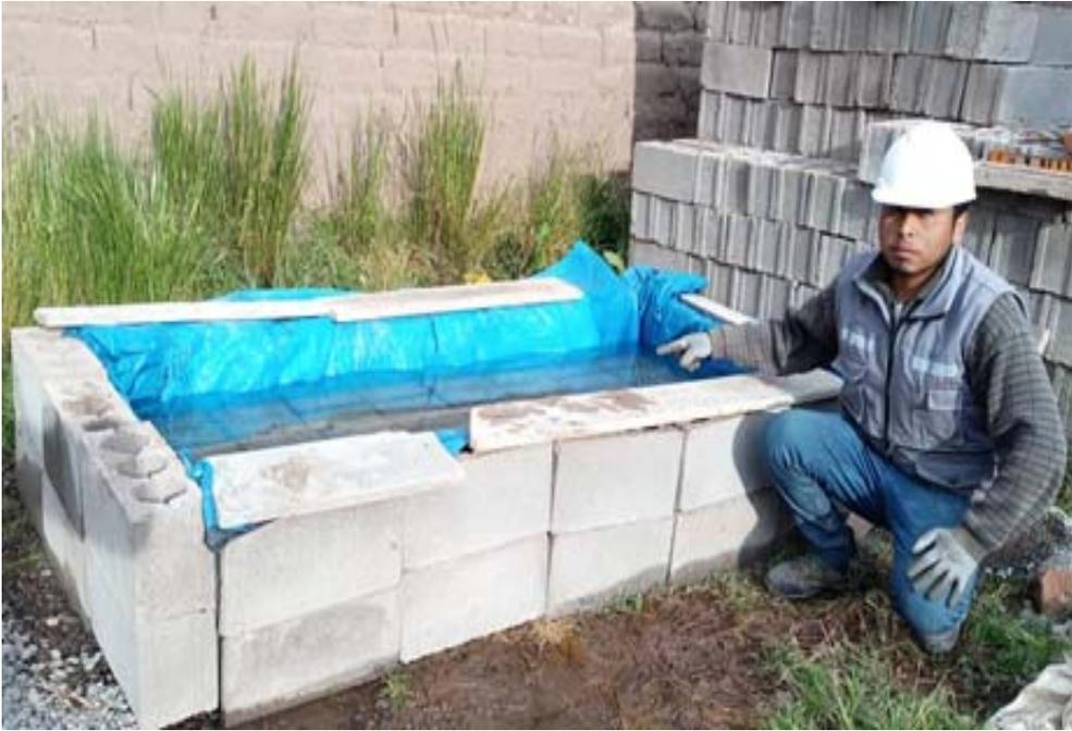
**Fotografía 30.** “Curado de las muestras de ladrillos”
