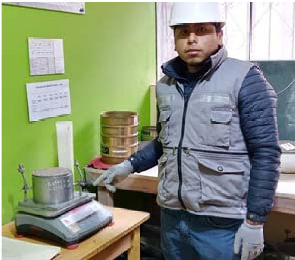
**Fotografía 16.** “Proceso de pesado de la muestra de Agregado Fino con el molde para el ensayo de Peso unitario suelto del Agregado Fino”
