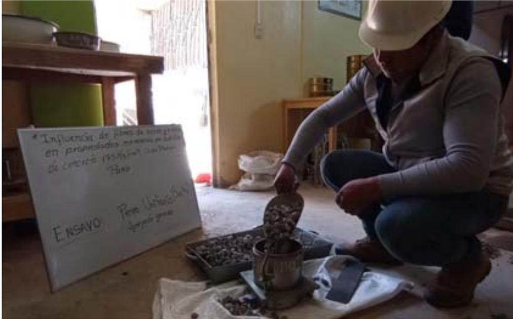
**Fotografía 9.** “Ensayo de Peso unitario suelto del Agregado Grueso”
