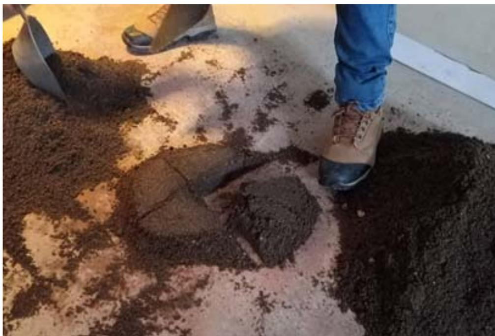
**Fotografía 1.** “Cuarteo de la muestra de Agregado fino”
