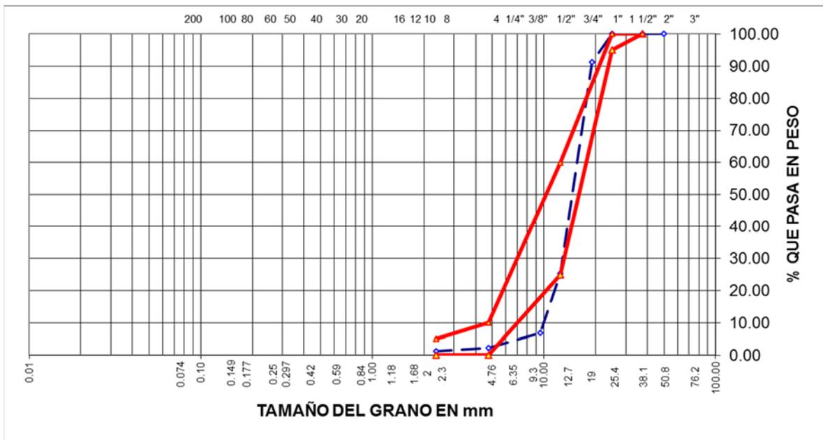
**Figura 7. Curva granulométrica del agregado grueso**
