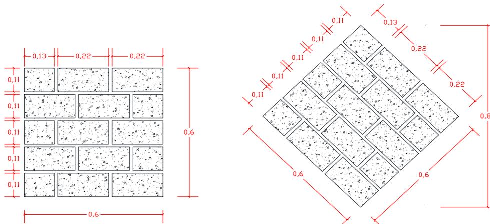
**Figura 15.** Dimensiones en m de los muretes en compresión diagonal
