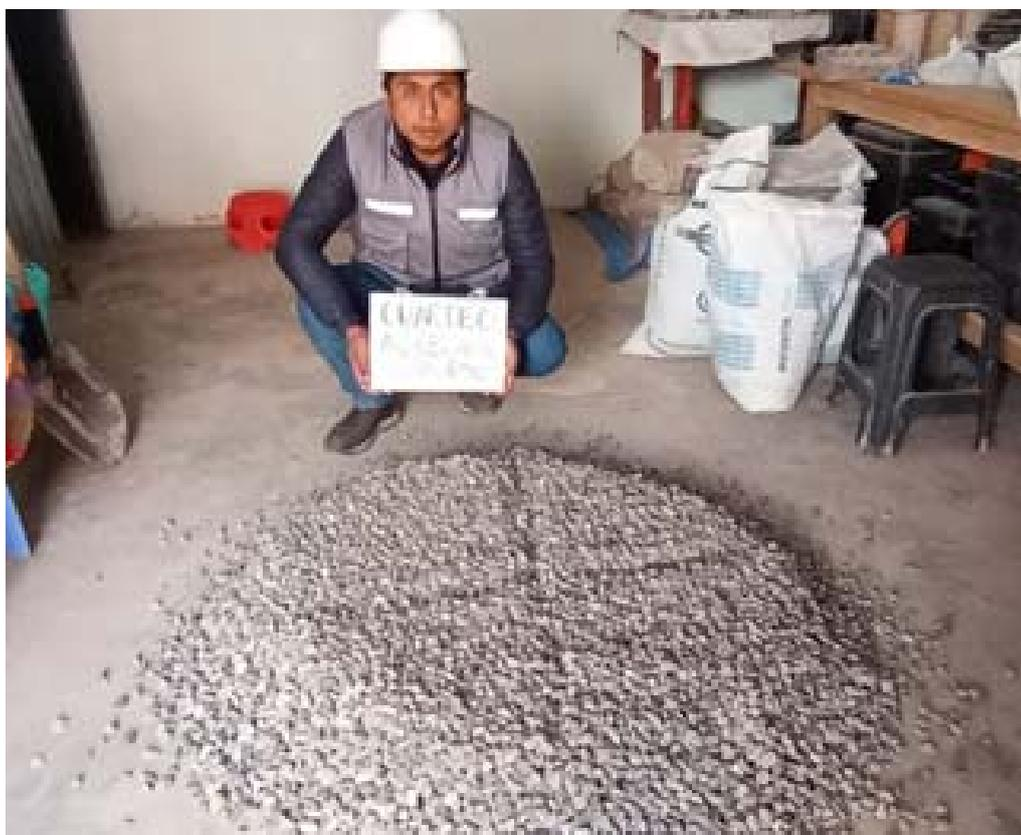
**Fotografía 2.** “Cuarteo de la muestra de Agregado grueso”
