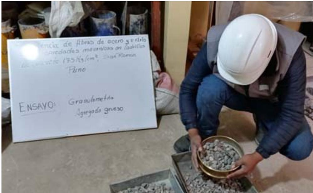
**Fotografía 8.** “Ensayo de Granulometría del Agregado Grueso mediante el proceso manual”
