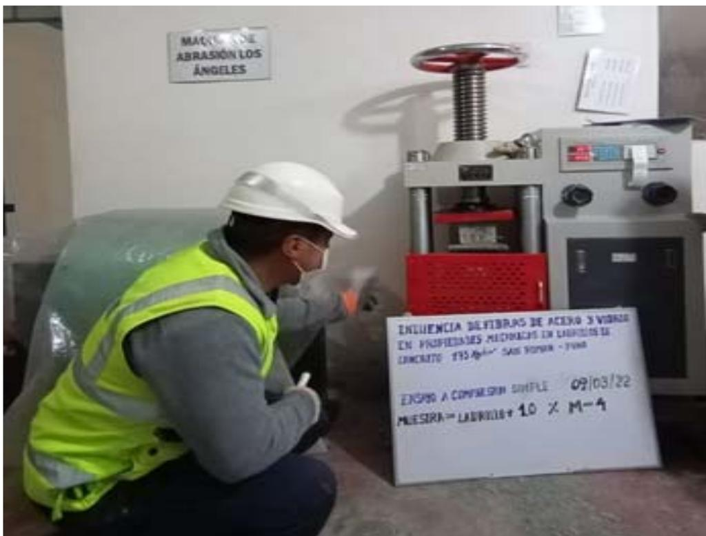
**Fotografía 42.** “Ensayo de compresión simple de las unidades de ladrillo a los 28 días”
