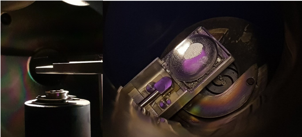
Abbildung 52: a) Position der Vibrationsbühne über der abgesenkten vorhandenen Bühne. b) Das Stahlbeschichtungsgefäß, fixiert durch den Fixierarm, mit Al 2 O 3 Nanopulver im LiF Plasma, das sich an einer Seite sammelt.
