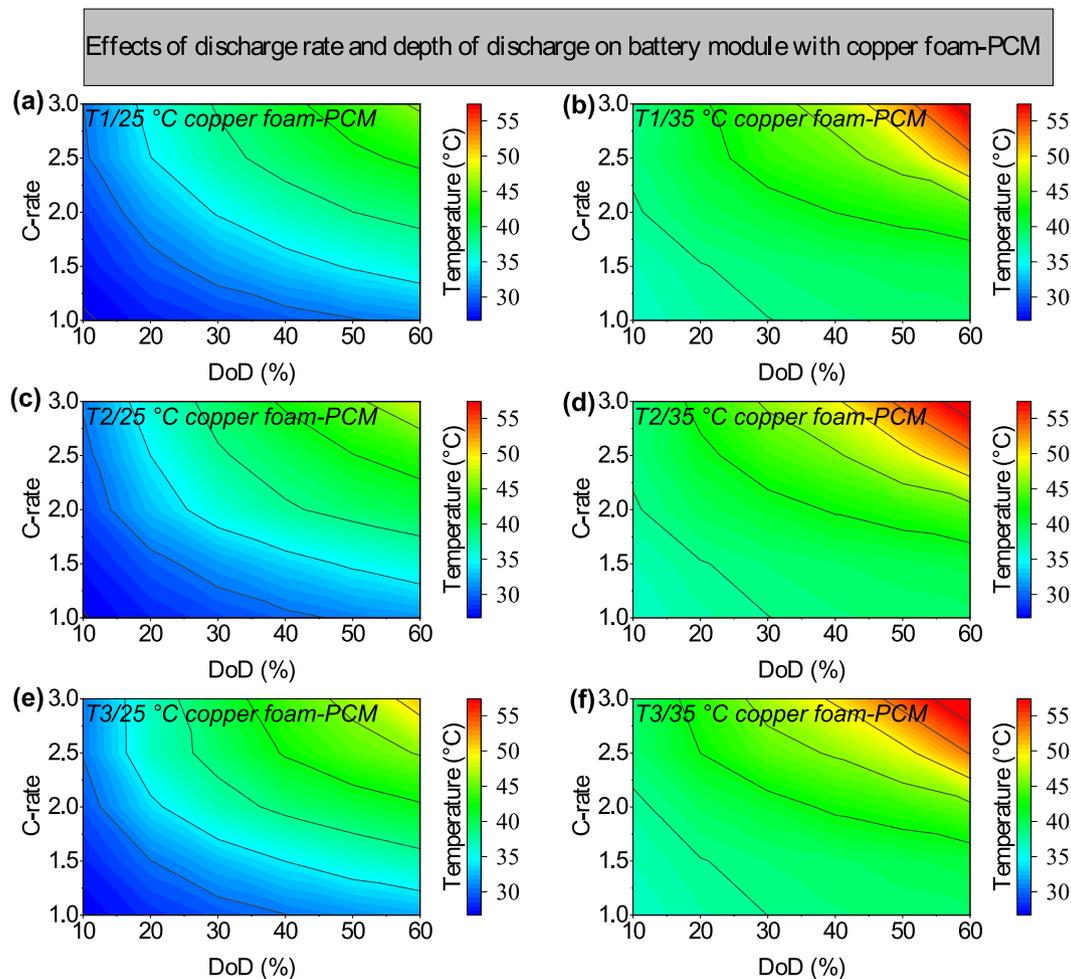
**Fig. A11.** Effects of discharge rate and depth of discharge on battery module with copper foam-PCM: (a) T1,  $T_{amb} = 25^\circ\text{C}$ ; (b) T2,  $T_{amb} = 35^\circ\text{C}$ ; (c) T3,  $T_{amb} = 25^\circ\text{C}$ ; (d) T1,  $T_{amb} = 35^\circ\text{C}$ ; (e) T2,  $T_{amb} = 25^\circ\text{C}$ ; (f) T3,  $T_{amb} = 35^\circ\text{C}$ .
