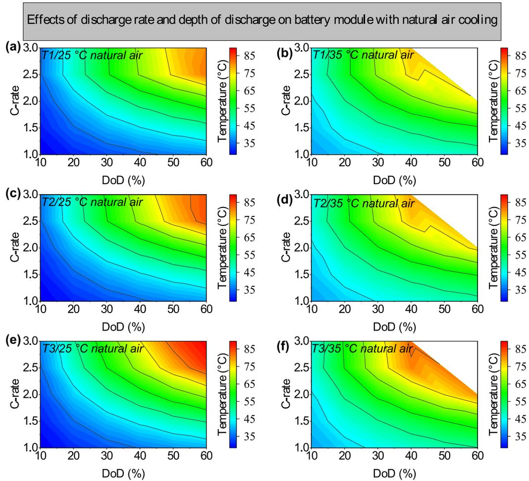
**Fig. A9.** Effects of discharge rate and depth of discharge on battery module with natural air: (a) T1,  $T_{amb} = 25\text{ }^{\circ}\text{C}$ ; (b) T2,  $T_{amb} = 35\text{ }^{\circ}\text{C}$ ; (c) T3,  $T_{amb} = 25\text{ }^{\circ}\text{C}$ ; (d) T1,  $T_{amb} = 35\text{ }^{\circ}\text{C}$ ; (e) T2,  $T_{amb} = 25\text{ }^{\circ}\text{C}$ ; (f) T3,  $T_{amb} = 35\text{ }^{\circ}\text{C}$ .
