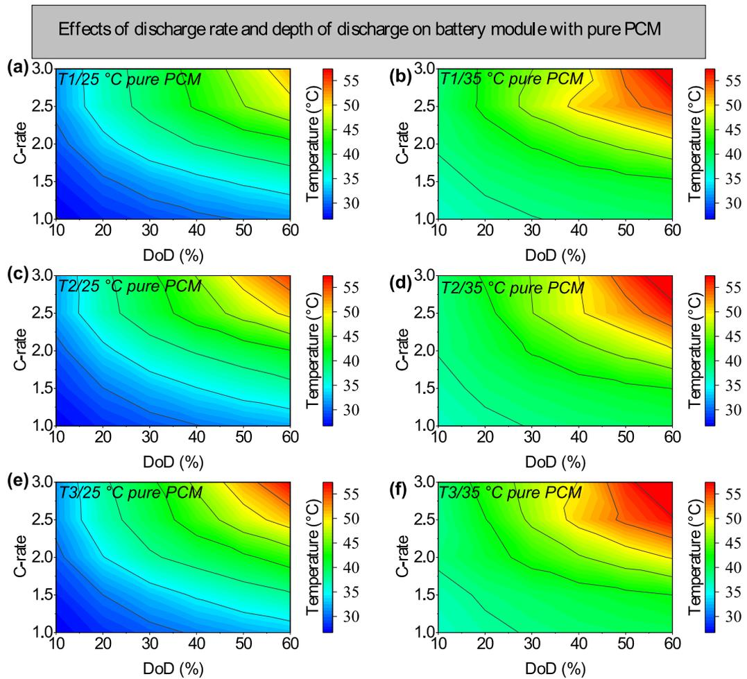
**Fig. A10.** Effects of discharge rate and depth of discharge on battery module with pure PCM: (a) T1,  $T_{amb} = 25\text{ }^{\circ}\text{C}$ ; (b) T2,  $T_{amb} = 35\text{ }^{\circ}\text{C}$ ; (c) T3,  $T_{amb} = 25\text{ }^{\circ}\text{C}$ ; (d) T1,  $T_{amb} = 35\text{ }^{\circ}\text{C}$ ; (e) T2,  $T_{amb} = 25\text{ }^{\circ}\text{C}$ ; (f) T3,  $T_{amb} = 35\text{ }^{\circ}\text{C}$ .
