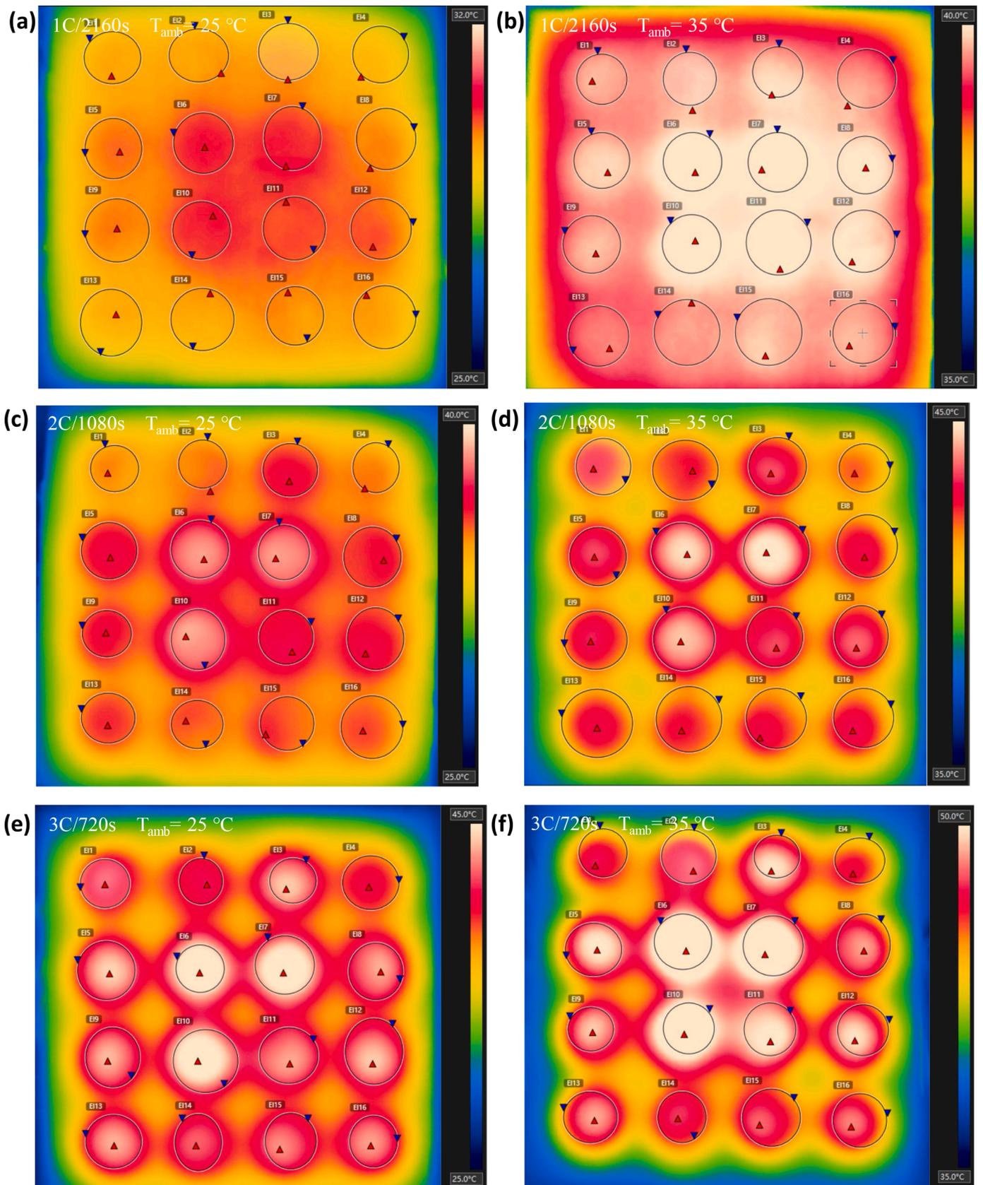
**Fig. A8.** The recorded infrared imagery of module under different discharge rate: (a) 1C,  $T_{amb} = 25\text{ }^{\circ}\text{C}$ ; (b) 1C,  $T_{amb} = 35\text{ }^{\circ}\text{C}$ ; (c) 2C,  $T_{amb} = 25\text{ }^{\circ}\text{C}$ ; (d) 2C,  $T_{amb} = 35\text{ }^{\circ}\text{C}$ ; (e) 3C,  $T_{amb} = 25\text{ }^{\circ}\text{C}$ ; (f) 3C,  $T_{amb} = 35\text{ }^{\circ}\text{C}$ .
