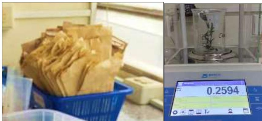
*Imagen 13: Pesaje de muestras etiquetadas después de ser expuestas a la estufa a 65°C para obtención de peso seco foliar y radicular*
