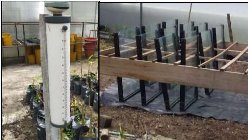
*Imagen 5: Adecuación del sitio experimental mediante la Instalación de un atmómetro e implementación de las unidades experimentales.*
