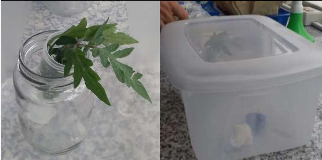
*Imagen 12: Exposición de foliolo a saturación en cámara húmeda para obtención del contenido relativo de agua*
