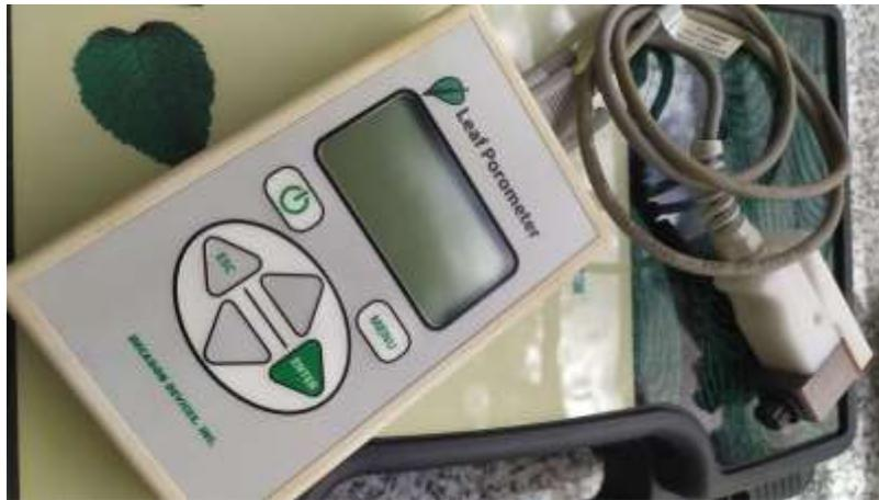
*Imagen 8: Medición de la conductancia estomática mediante la utilización de un porómetro*
