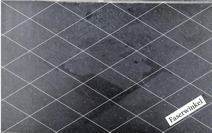
Abbildung 7.12.: Charakteristischer Abdruck auf der Gleitbuchse mit zusätzlich dargestelltem Wickelmuster als überlagertes Raster
