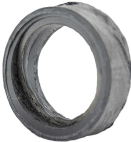
Abbildung 7.17.: Exemplarisches Versagensbild einer Probe nach Durchführung der Scherfestigkeitsprüfung der Gleitlager
