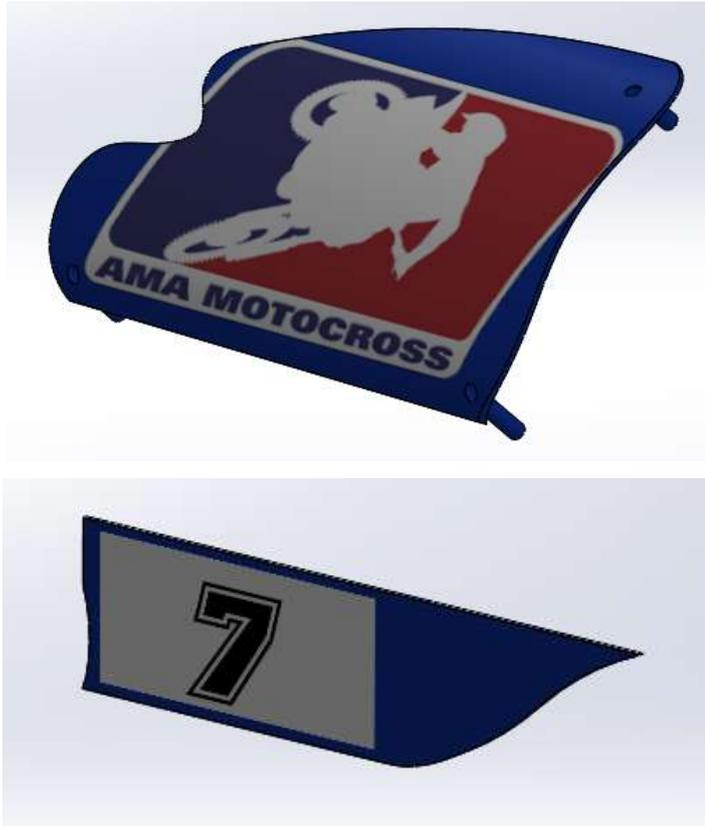
*Figura 2. 63. Modelo CAD. Carenados laterales con logotipos*
