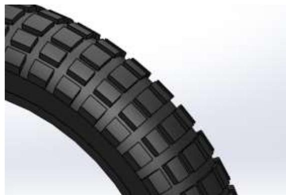
*Figura 2. 388. Detalle labrado del neumático trasero*
