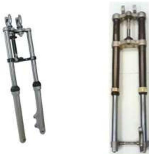
*Figura 2. 17. Comparativa entre horquilla convencional e invertida [50]*
