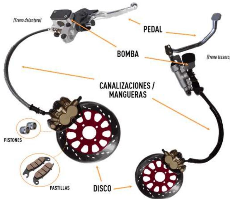
Figura 2. 57. Partes del sistema de freno de disco en una motocicleta [61]
