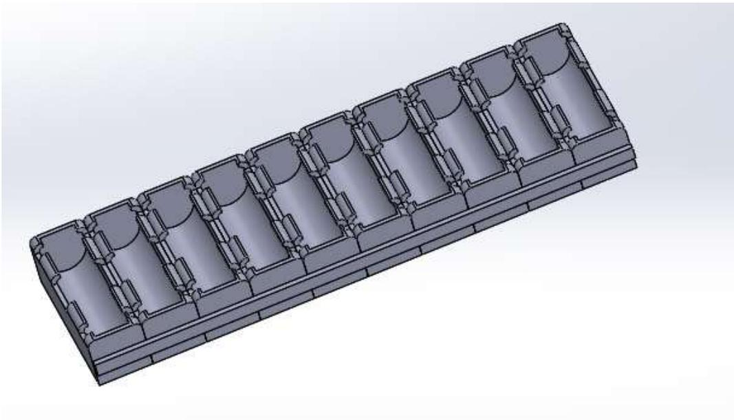
Figura 2. 48. Modelo CAD Portaceldas izquierdo
