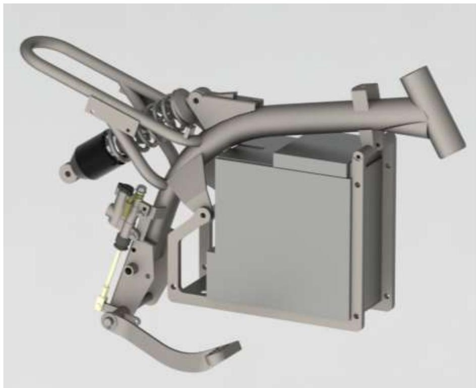
*Figura 3. 3. Renderizado Chasis – Batería*
