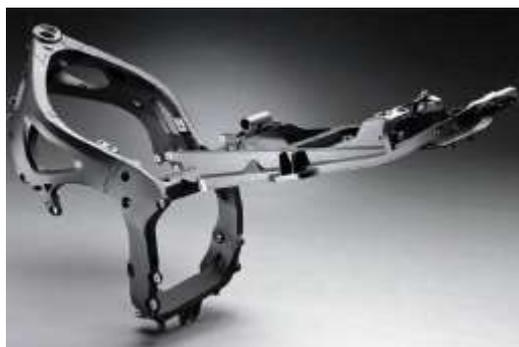
*Figura 2. 7. Chasis de doble viga perimetral cerrado [44]*
