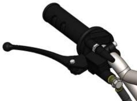
*Figura 2. 61. Modelo CAD. Freno de manillar*
