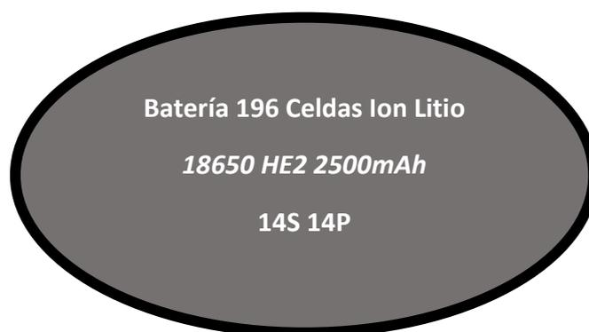
Figura 2. 44. Datos de la configuración de la batería.
