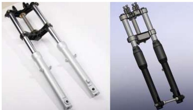
*Figura 2. 24. Comparativa Suspensión delantera real vs modelo CAD*
