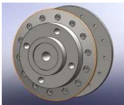
*Figura 2. 42. Buje llanta delantera*
