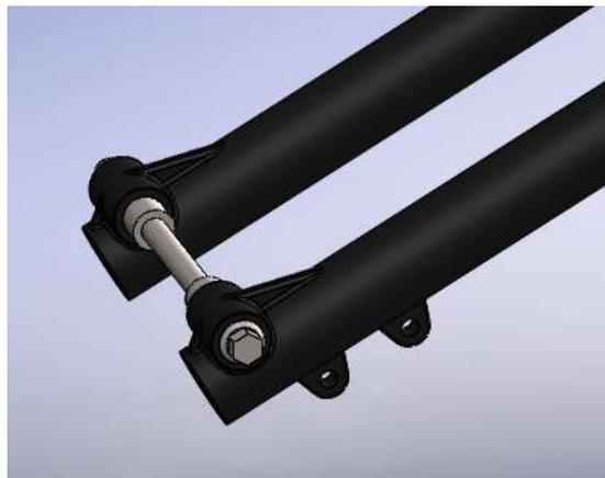
*Figura 2. 27. Detalle nervio de la parte inferior de la horquilla*
