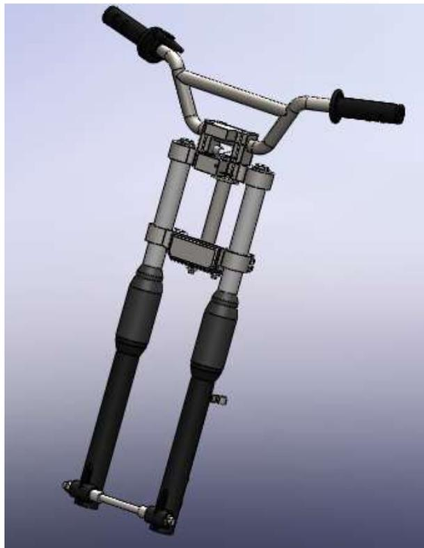
*Figura 2. 23. Modelo CAD Suspensión delantera*
