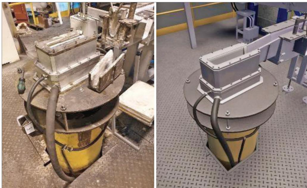
Рис. 3. Кристаллизатор (а) и скриншот его виртуальной модели (б)
