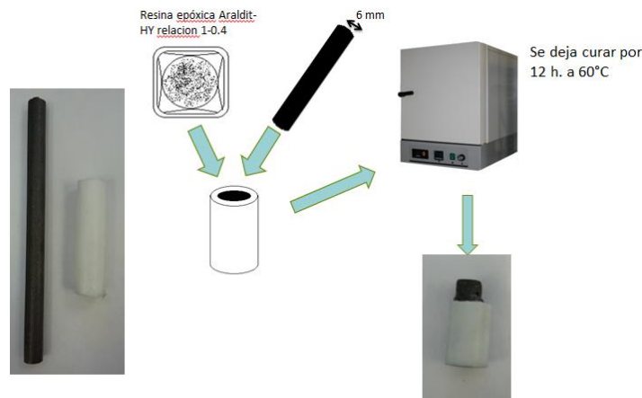
Figura 2. Construcción del electrodo de trabajo
