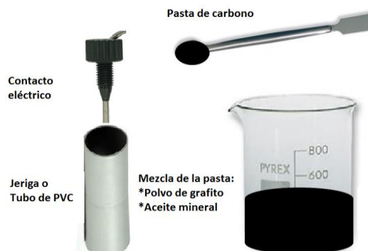
Figura 2. Construcción del electrodo de pasta de carbono.
