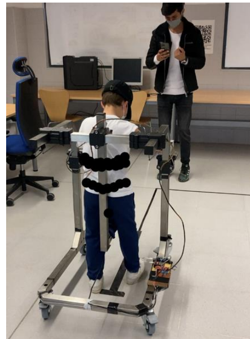
Figura 7. Entorno experimental para la prueba del prototipo de andador posterior sensorizado.
