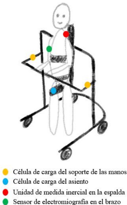
Figura 1. Boceto de la estructura de verticalización sensorizada.
