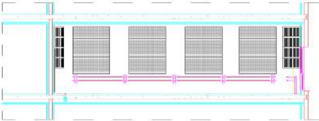
ESQUEMA DE COLOCACIÓN PANELES DE PARED Y TRAMPAS DE GRAVES (Ecophon Akusto™ Wall y STREKKOD HP)
