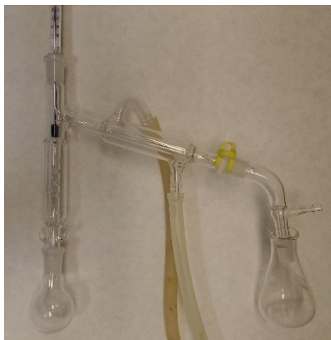
Imagen 4. Montaje equipo de destilación de laboratorio. Elaboración propia.
