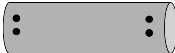
Ilustración 10: Esquema de los agujeros que se deben hacer en las tuberías.
