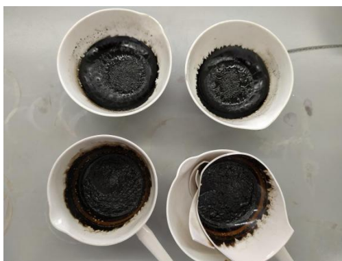
Figura 25 - Imagem ilustrativa das amostras secas na estufa, a T=103-105 °C.
