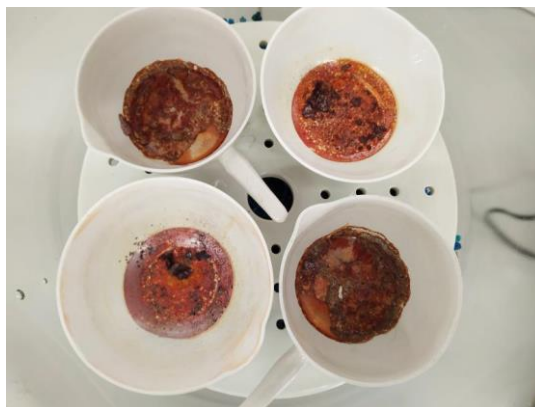
Figura 26 - Imagens ilustrativas das amostras secas na mufla, a T=700°C.
