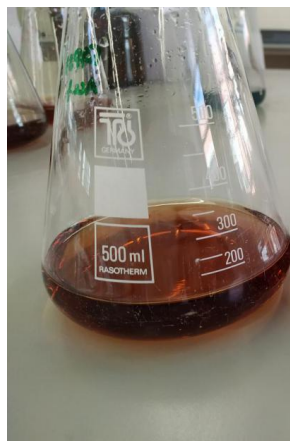
Figura 24 - Imagem ilustrativa do final titulação da amostra de CQO.
