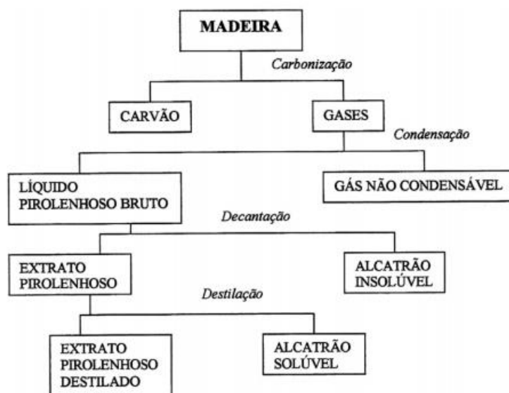
Figura 12 - Esquema do processo de obtenção do EPL. FONTE: (Miyasaka, et al.,1999).
