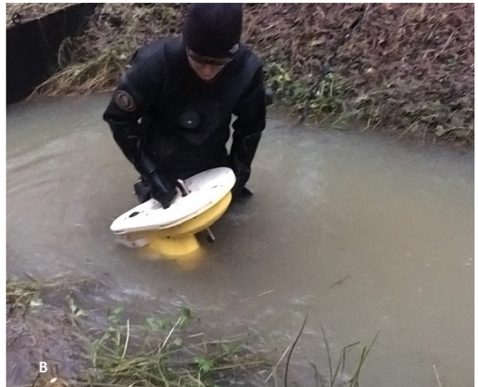
Kuva 15. A) Automaattinen THOË -näytteenotin (kuva: DGT Research, 2022), ja B) sen altistaminen. Kuva: Luode Consulting Oy.
