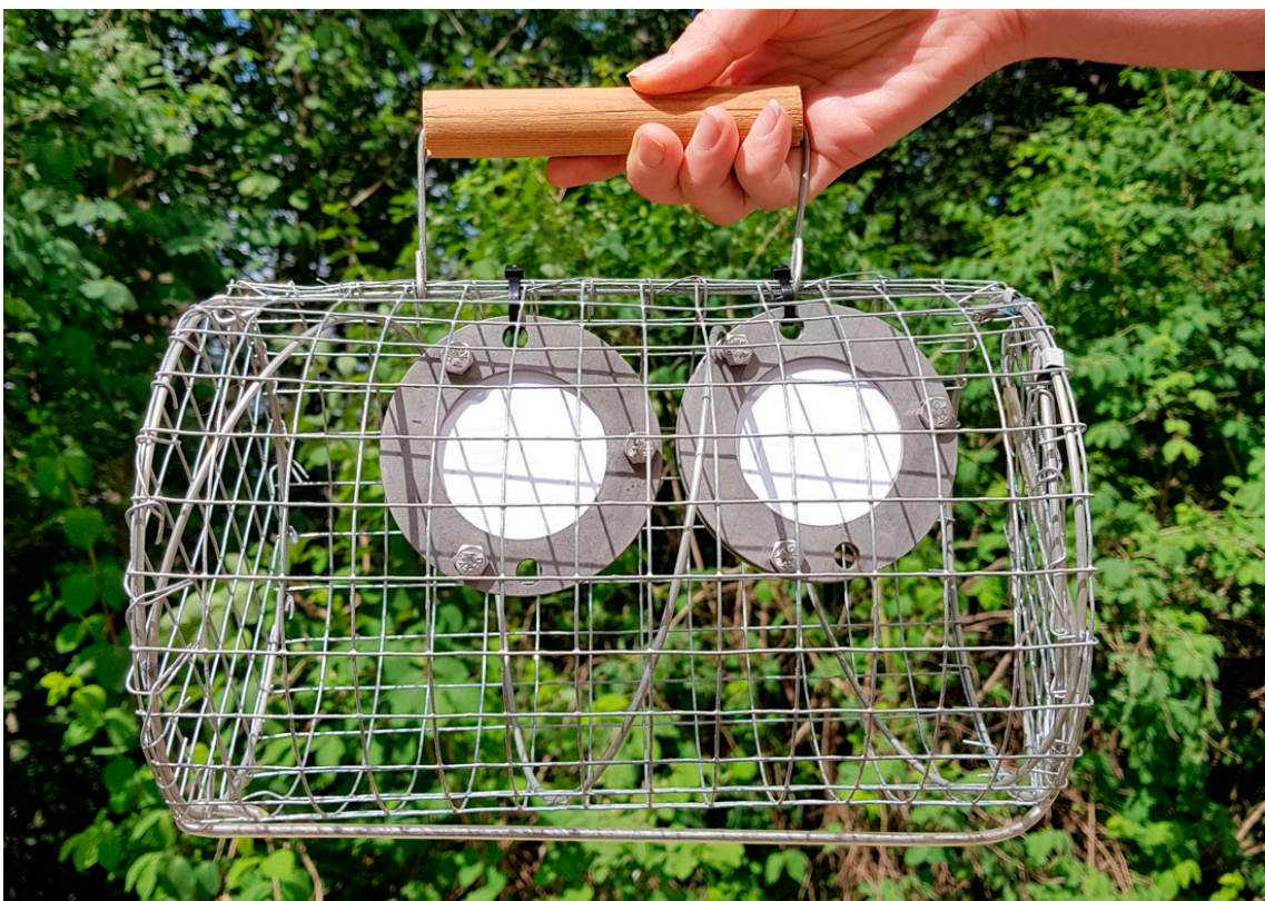
Kuva 3. POCIS keräimet perunanpesimessä. Kuva: Heidi Ahkola, Syke.
