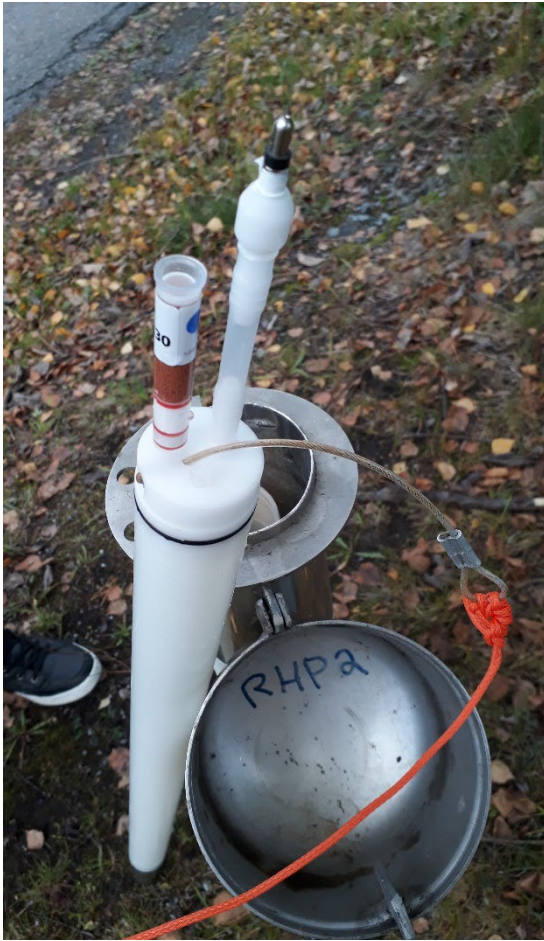
Kuva 6. SorbiCell-keräimen pohjavesialtistussäiliö. Kuva: Heidi Ahkola, Syke.
