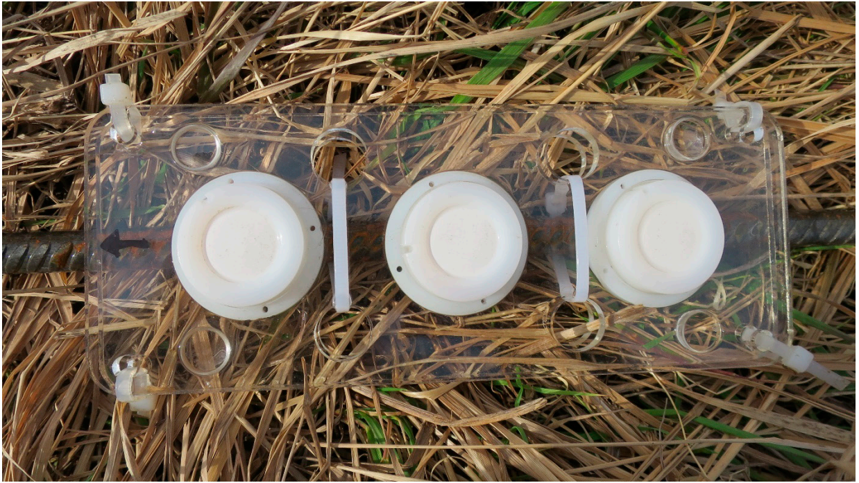
Kuva 14. DGT-keräinten altistuskehikko. Kuva: Maria Kämäri, Syke.
