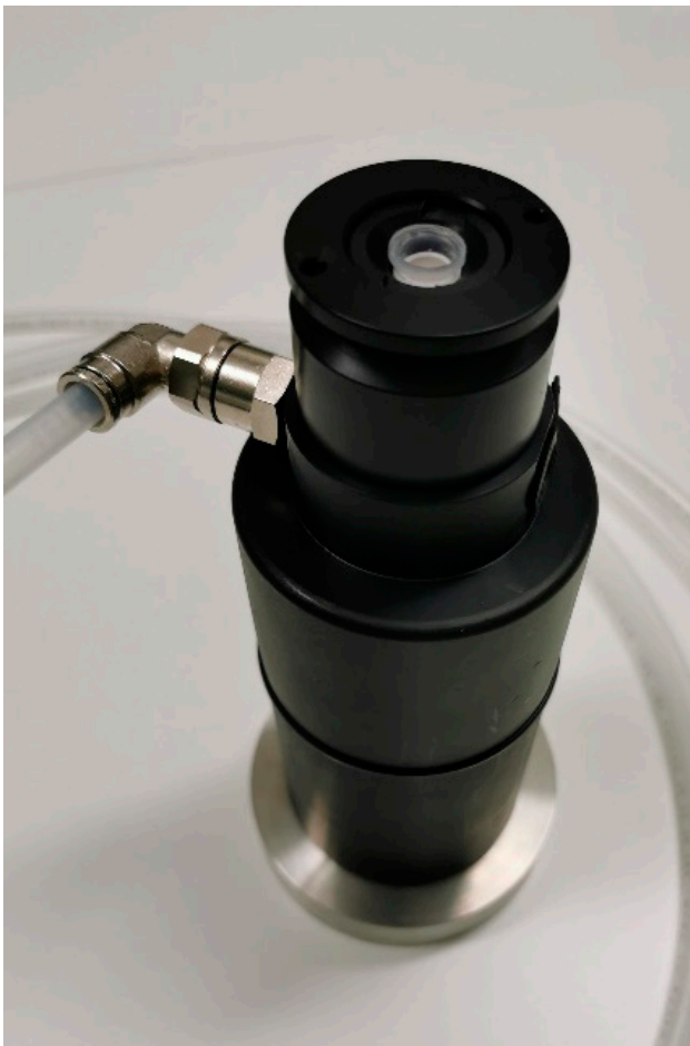
Kuva 5. SorbiCell -keräimen pintavesialtistussäiliö. Kuva: Heidi Ahkola, Syke.
