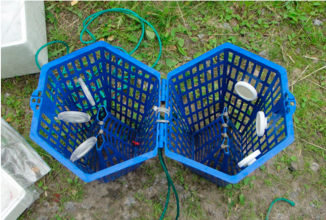
Kuva 4. Chemcatcher-keräimiä rapumerrassa. Kuva: Heidi Ahkola, Syke.
