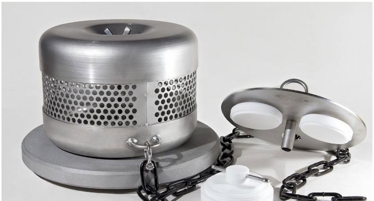
Kuva 10. PTFE-runkoisen Chemcatcher-keräimen altistushäkki. Kuva: chemcatcher.ie.
