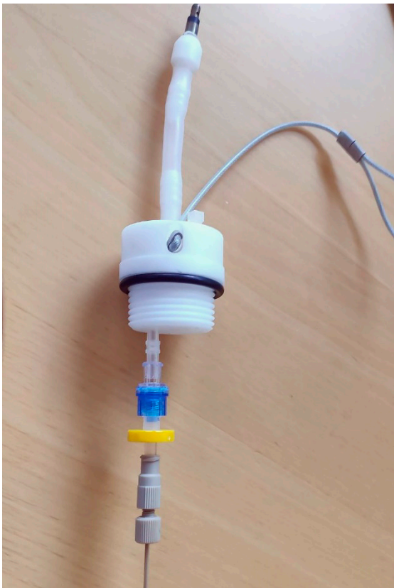
Kuva 19. Virtausta hidastava suodatin pohjavesisäiliössä. Kuvat: Heidi Ahkola, Syke.
