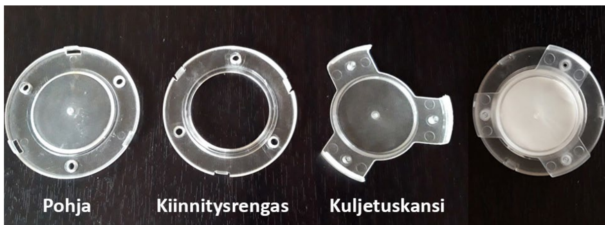
Kuva 7. Polykarbonaattirunkoinen Chemcatcher-keräin, jossa vastaanottavana faasina Empore levy. Kuvat: Heidi Ahkola, Syke.
