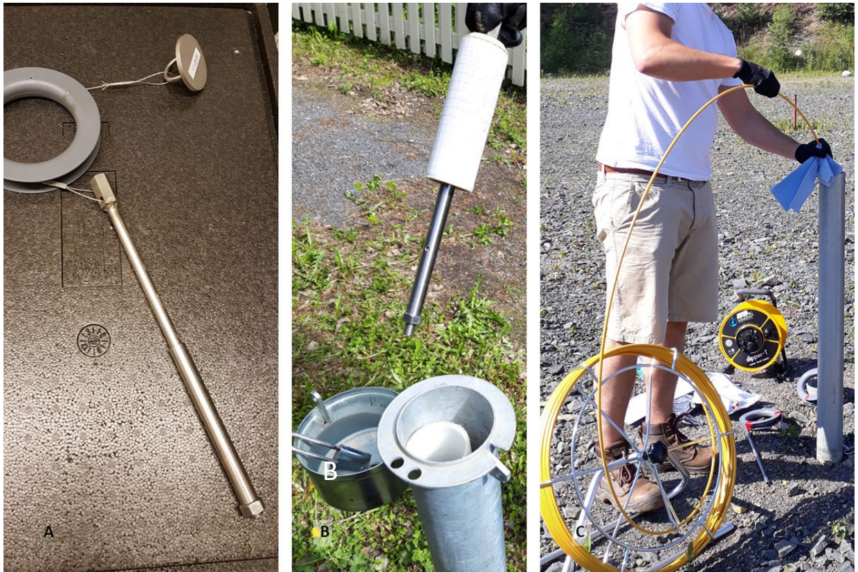
Kuva 24. A) iFlux-keräimen kiinnitystanko ja ripustusvaijeri ja B) ja C) keräimien asentaminen pohjavesiputkeen sujutusvaijerin avulla. Kuvat: Heidi Ahkola, Syke.
