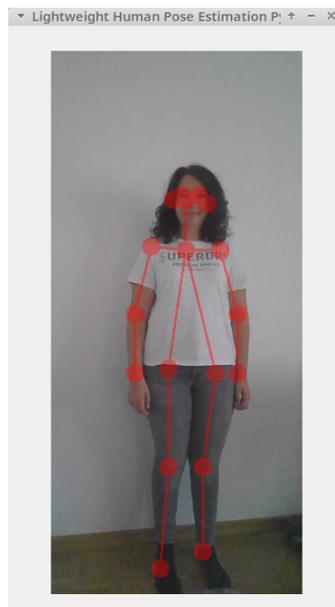
Abbildung 4.4: Beispielbild des Videostreams der Gelenkpositionserkennungssoftware
