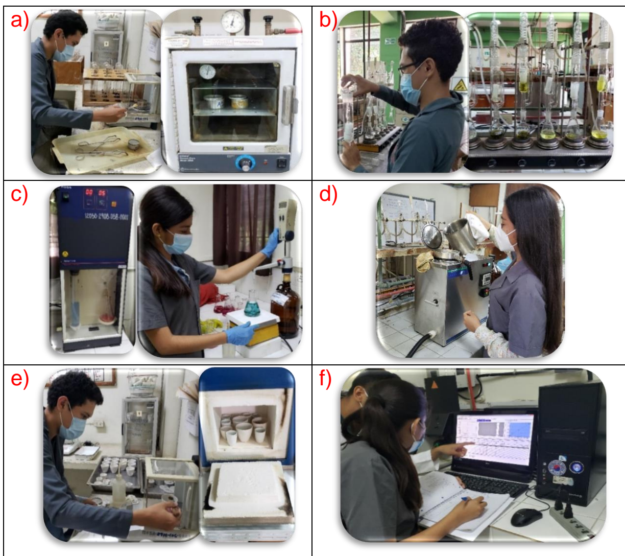
Figura 8. Metodología de laboratorio. a) Humedad total. b) Extracto Etéreo. c) Proteína cruda. d) Fibra cruda. e) Cenizas. f) Minerales.
