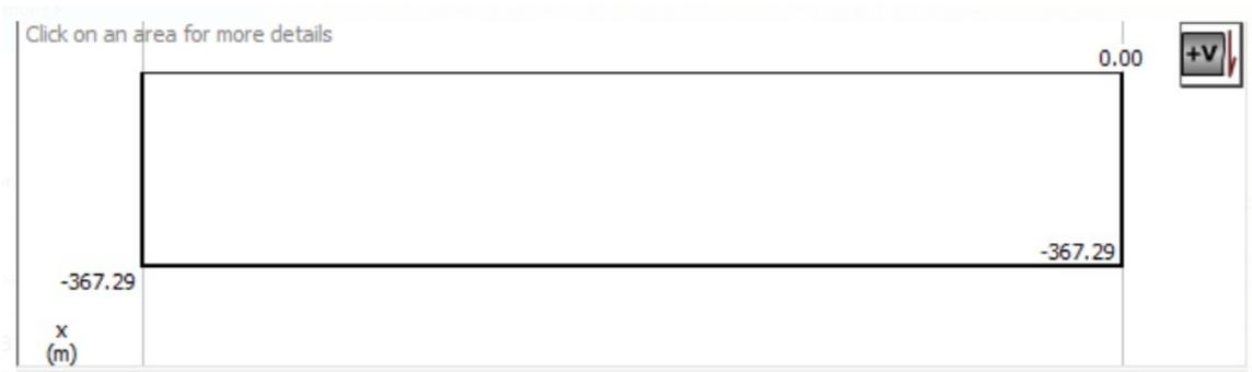
Figura 70. Diagrama de fuerza cortante del plano x-z
