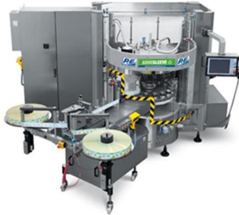
Figura 8. Máquina etiquetadora rotativa [8]
