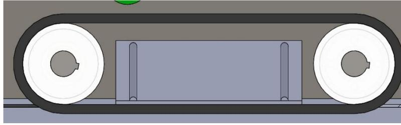
Figura 85. Placa soporte de banda
