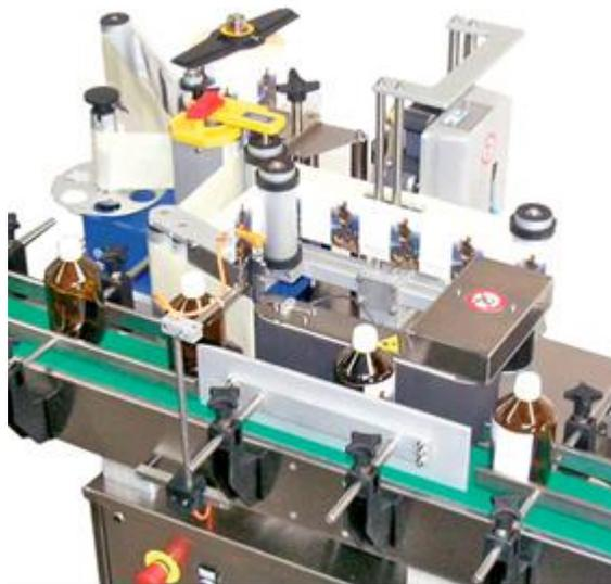
Figura 9. Máquina etiquetadora lineal [9]
