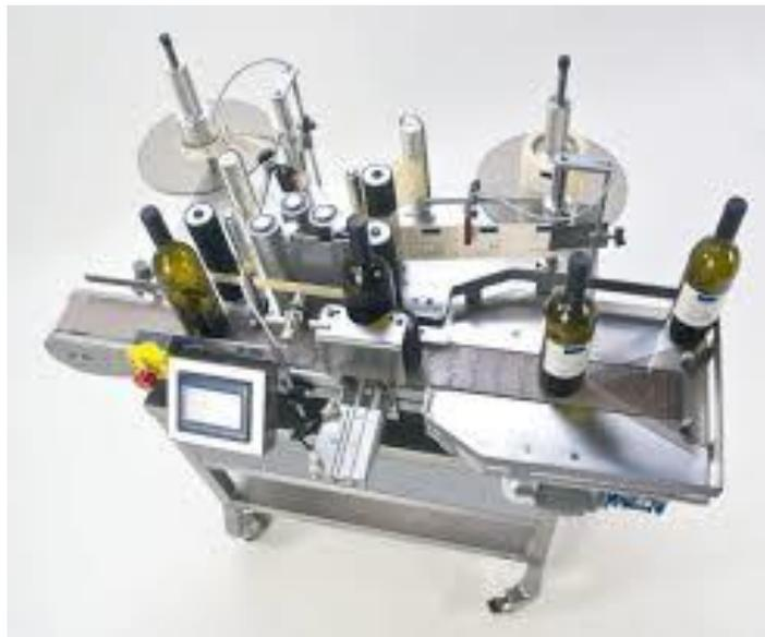
Figura 6. Etiquetadora automática [6]
