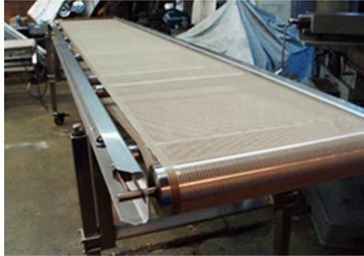
Figura 14. Banda transportadora de teflón y silicona [14]
