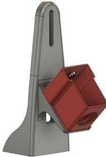
Ilustración 25: Fijación de la carcasa y pantalla a la célula
