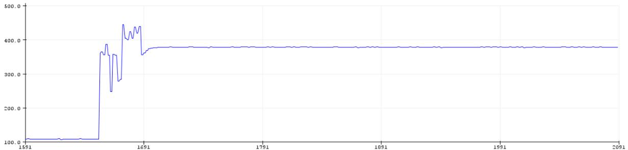
Figura 18. Salida del motor, posición angular, con control PID de valores de  $K_p = 50$ ,  $K_i = 3$  y  $K_d = 0.5$ . Eje x tiempo en ms y eje y voltaje.
