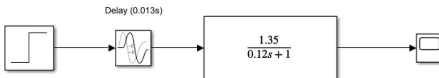
Figura 29. Esquema de control en lazo abierto de la planta del servomotor en *Simulink*.
