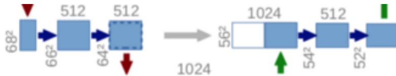
Figura 2.19: Ejemplo de una convolución transpuesta de la red UNet .
