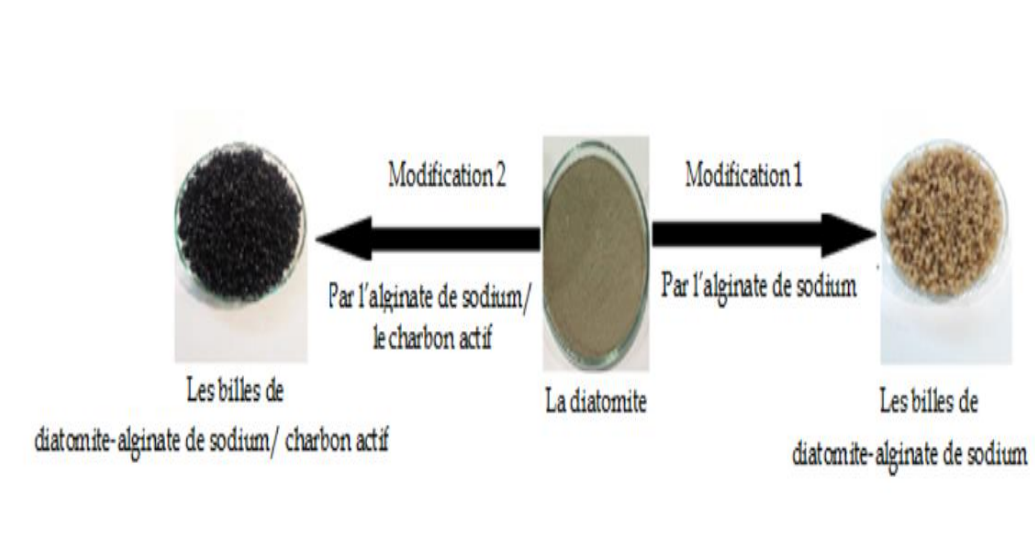
Figure II.9 : Modification de la diatomite par l'alginate de sodium et le charbon actif (forme de billes)
