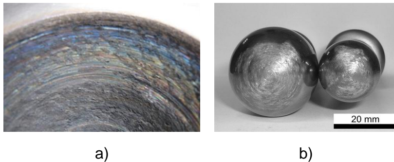
Figura IV-1. Empleo de herramienta tipo punzón metálica en SPIF de Ti-6Al-4V en caliente: a) Calidad superficial de una pieza obtenida por Fan et al. [Fan, 2010] y b) Desgaste de la herramienta utilizada por Göttman et al. [Göttmann, 2011].
