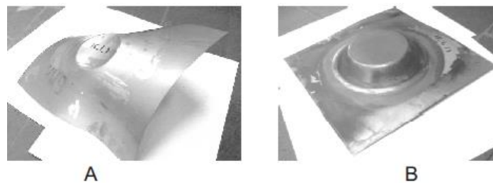
Figura II-24. Geometría de Ti-6Al-4V obtenida con las variantes de proceso en frío (A) y caliente (B) por Duflou et al. [Duflou, 2007].
