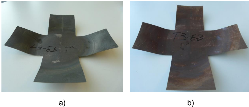
Figura III-65. Muestras en forma de cruz extraídas de piezas fabricadas para analizar el efecto del tipo de enfriamiento: a) E1 y b) E2.
