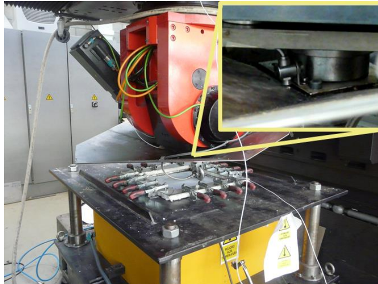
Figura IV-13. Localización del pirómetro móvil para control de temperatura durante la etapa de conformado.
