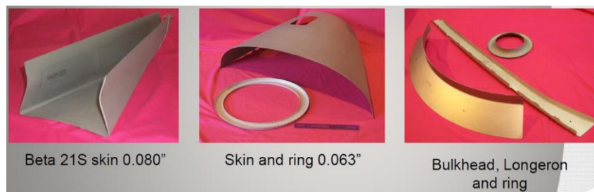
Figura II-2. Ejemplos de piezas fabricadas mediante "Hot Forming" [Swale, 2010].
