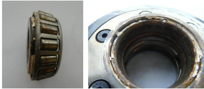
Figura IV-28. Estado de rodamiento y pista de rodamiento (los más cercanos a la pared de la pieza) después de ensayo de SPIF en caliente con la herramienta nueva y condiciones de trabajo iniciales.
