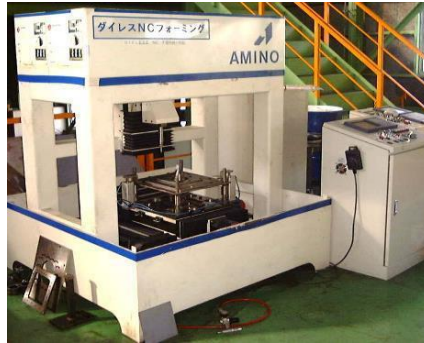
Figura II-5. Primer prototipo de máquina “Dieless forming” de AMINO [Amino, 2014].
