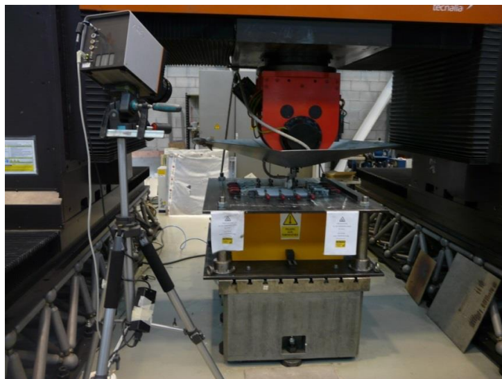
Figura III-19. Medición de la temperatura de la cara superior de la chapa con la cámara termográfica.
