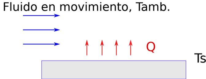
Figura A.2. Transferencia de calor mediante convección.
