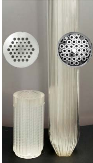
Figura 2.23. Dos preformas creadas en nuestro laboratorio. A la izquierda, una preforma obtenida empleando la técnica de taladrado. A la derecha, una preforma obtenida empleando la técnica de apilamiento de capilares.
