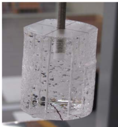
Figura 2.5. Imagen de una preforma de PMMA con burbujas, tras el calentamiento en el horno de la torre de estirado. Estas burbujas evidencian la ausencia del proceso de recocido necesario durante la fase de fabricación de la preforma.
