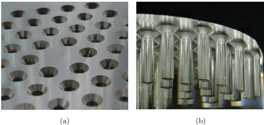
Figura 2.13. (a) Imagen del extremo superior de la preforma en la cual se observan los ángulos de entrada a los agujeros, creados con la broca de avellanado. (b) Imagen lateral del extremo superior de la preforma, en la cual se observan los 10 mm de profundidad taladrados empleando la broca piloto.
