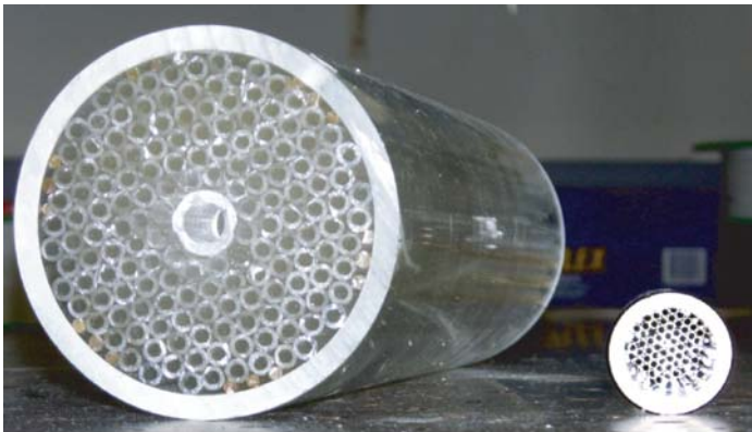
Figura 2.24. Preforma de 80 mm de diámetro creada empleando la técnica de apilamiento de capilares, con anillos hexagonales y núcleo hueco. El espaciador o agujero central de la preforma sólo está presente en los extremos de la misma. La pequeña preforma de la derecha es una preforma convencional de sílice.
