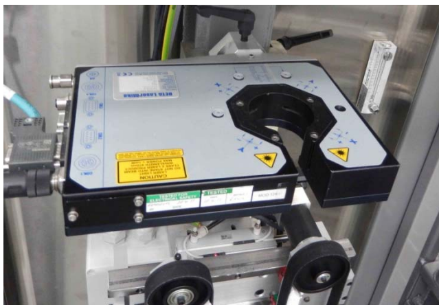
Figura A. 20 Detalle de la unidad de control de diámetro de la fibra
