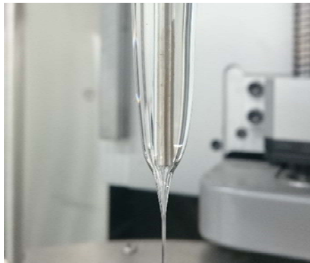
Figura 3.8. Preforma de PMMA con el termopar embebido tras el estirado.
