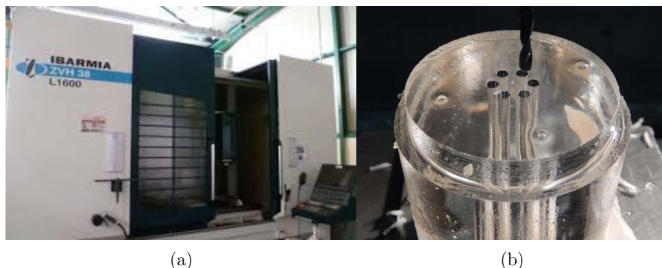
Figura 2.7. (a) Centro de control numérico empleado para el taladrado de las preformas. (b) Fabricación de una preforma empleando taladrado por extracción de viruta.
