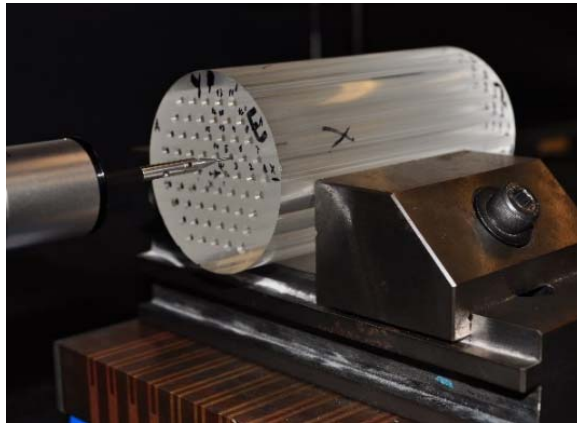
Figura 2.17. Detalle del palpador correspondiente al sistema Mitutoyo 7106, junto con una preforma analizada.
