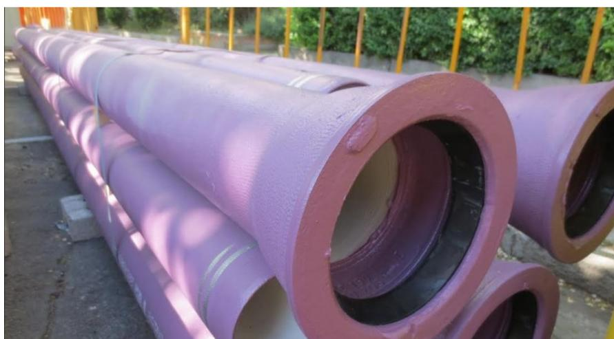
Figura 34: Tuberías de fundición dúctil para aguas regeneradas (Fuente: Saint Gobain Pam)
