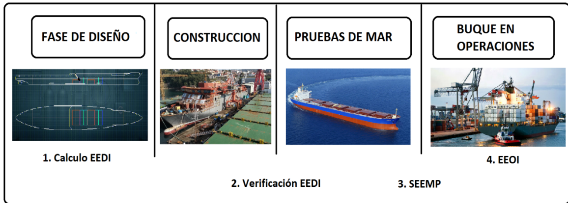
Figura 3.12: Herramientas EEDI, SEEMP y EEOI durante las distintas fases de la vida del buque [Autor]
