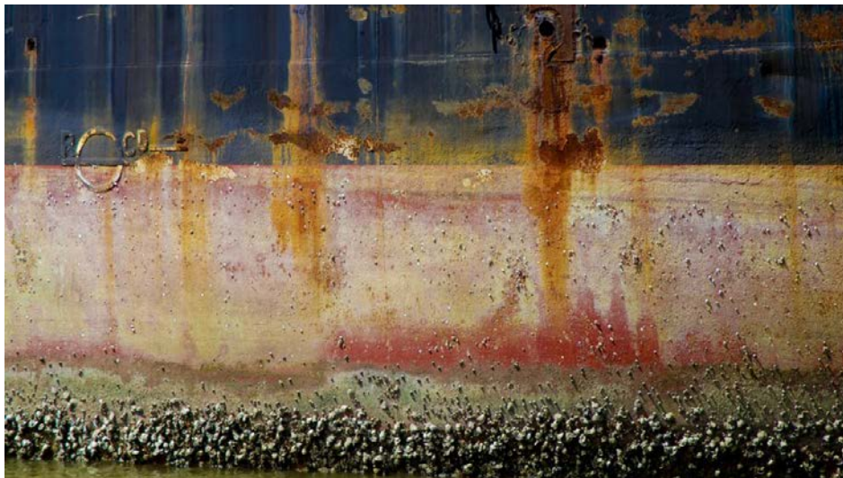
Figura 4.14: Casco de un buque con fouling [17]
