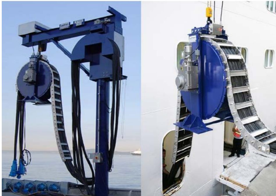
Figura 4.4: Ejemplo de grúa con base fija (izquierda) y operación de conexión de buque (derecha) [32]
