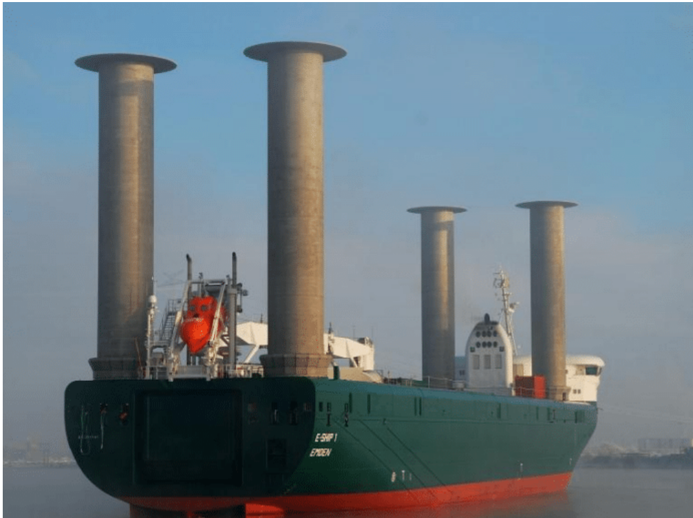
Figura 4.13: Buque actual con los rotores Flettner [37]
