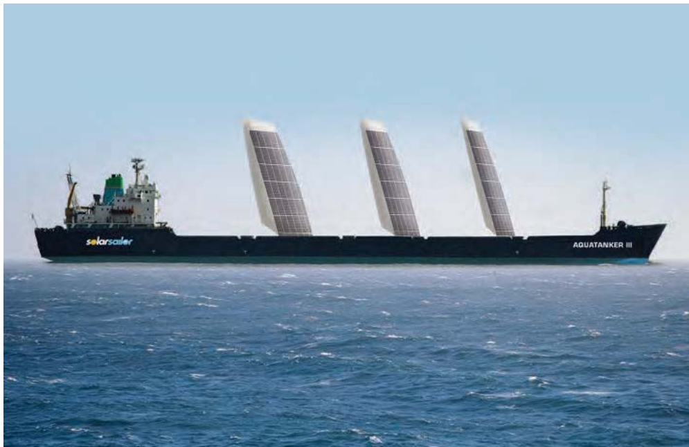
Figura 4.8: Diseño conceptual para el aumento del área de paneles solares [31]
