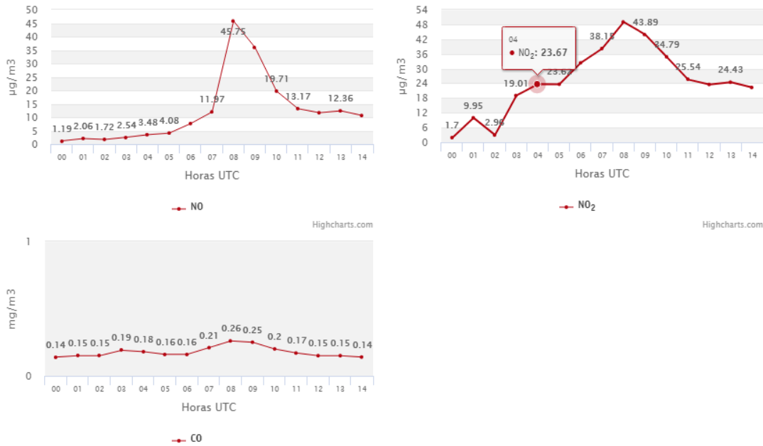
Figura 3.17: Cantidades en \mu\text{g}/\text{m}^3 y \text{mg}/\text{m}^3 de óxidos de nitrógeno y óxidos de carbono respectivamente [21]
