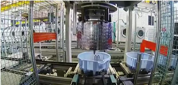
Ilustración 16: unión del tambor y parte trasera de la lavadora
