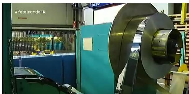
Ilustración 8: desbobinado del acero inoxidable
