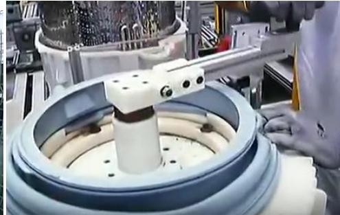
Ilustración 15: premontaje del fuelle
