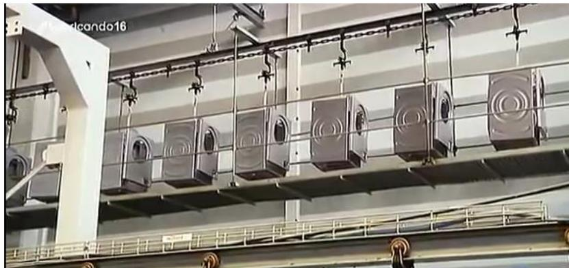
Ilustración 14: línea del mueble de la lavadora
