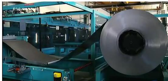
Ilustración 3: extensión de la plancha de chapa
