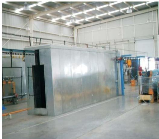
Ilustración 41: horno de convección
