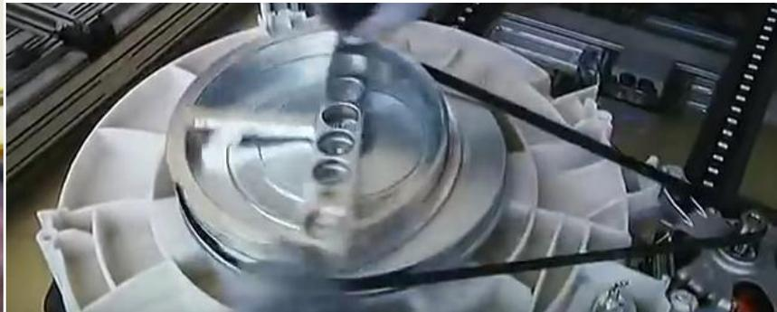
Ilustración 20: correa de transmisión del movimiento
