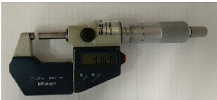
Imagen 8. Micrómetro de exteriores, ME-1041
