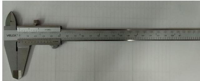
Imagen 3. Calibre pie de rey analógico (0-200), PR-1271
