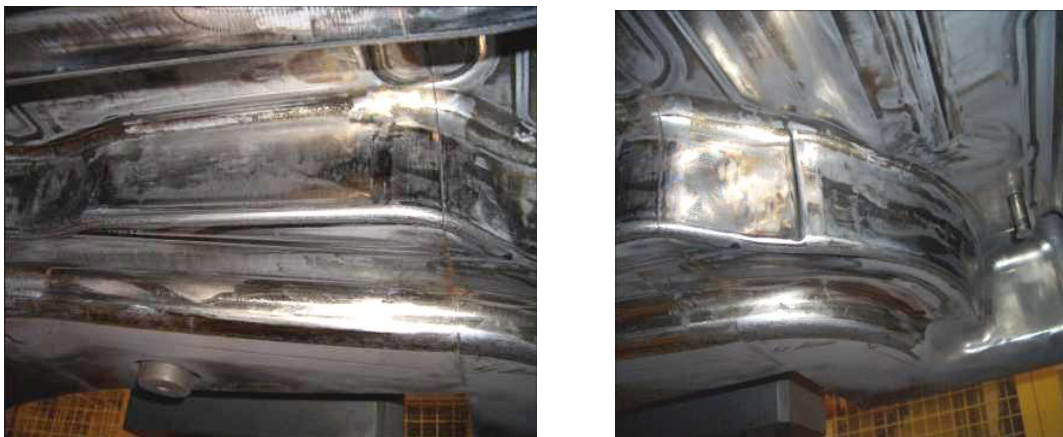
Figura I. 19. Representación del desgaste adhesivo en herramientas de estampación en caliente [Cengotitabengoa, 2009].
