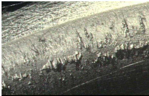
Figura I. 13. Aspecto de cavidades, rayas y acumulación de material característico del desgaste adhesivo.
