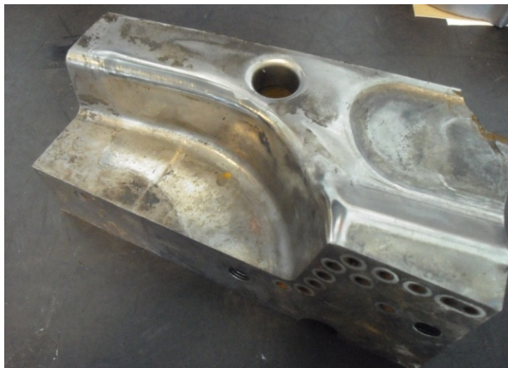
Figura I. 18. Detalle del desgaste que presenta un casete de un utillaje para estampación en caliente.
