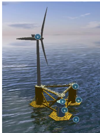
Imagen 16: Sistema de flotación WindFloat. (Fuente: Principle Power [Anexo IV])
