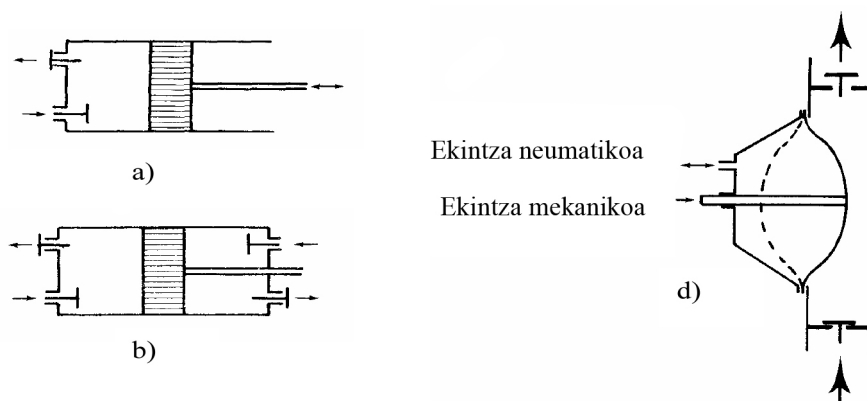
6.12 irudia. Txandakako ponpak: a) pistoi erakoa, b) bikoitza, d) diafragma.
