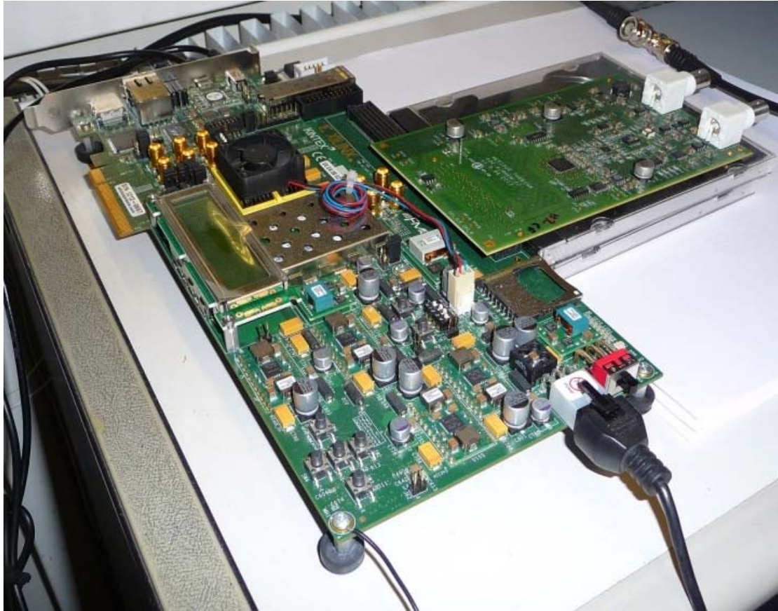
Figura 44. Prototipo para la medida del TC y ToA basada en KC705.
