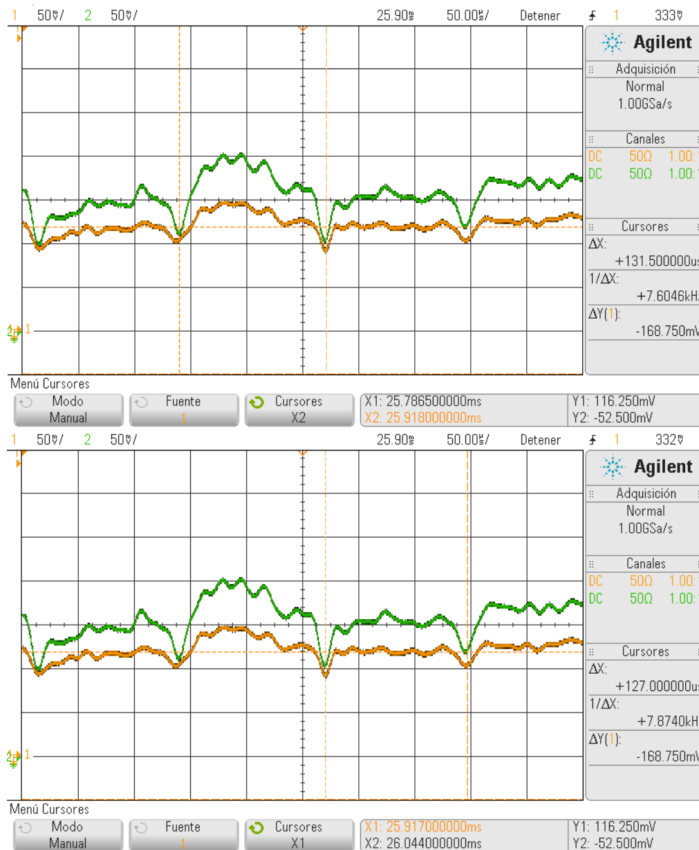
Figura 29. Detalle de las formas de onda adquiridas a una velocidad de giro de 3225 rpm. El osciloscopio muestra el tiempo de dos álabes consecutivos.
