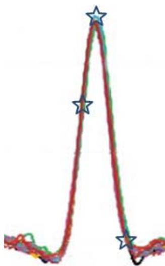
Figura 23. Ejemplo de instantes que pueden ser usados en la determinación de la detección del álabes.
