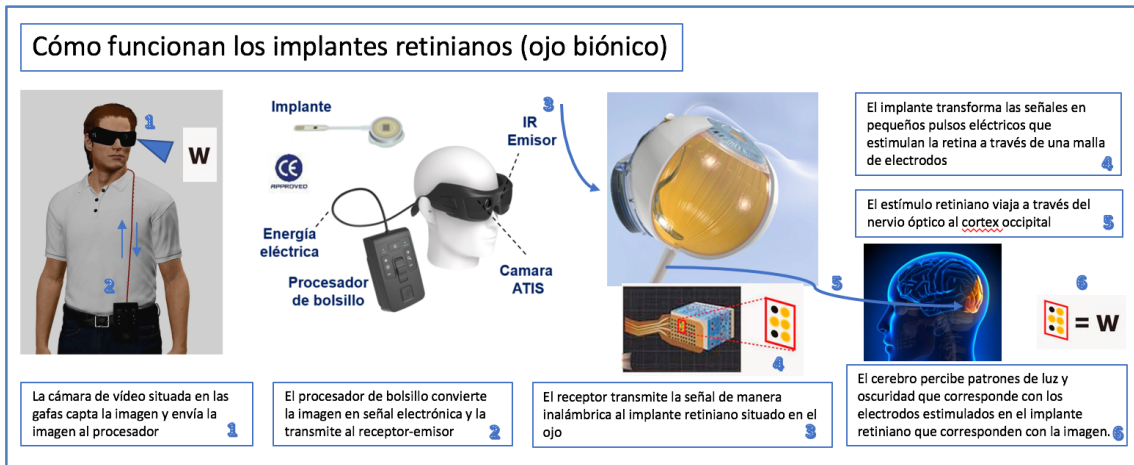
Figura 21. Esquema de funcionamiento de las prótesis retinianas. Imágenes cedidas por Pixium.
