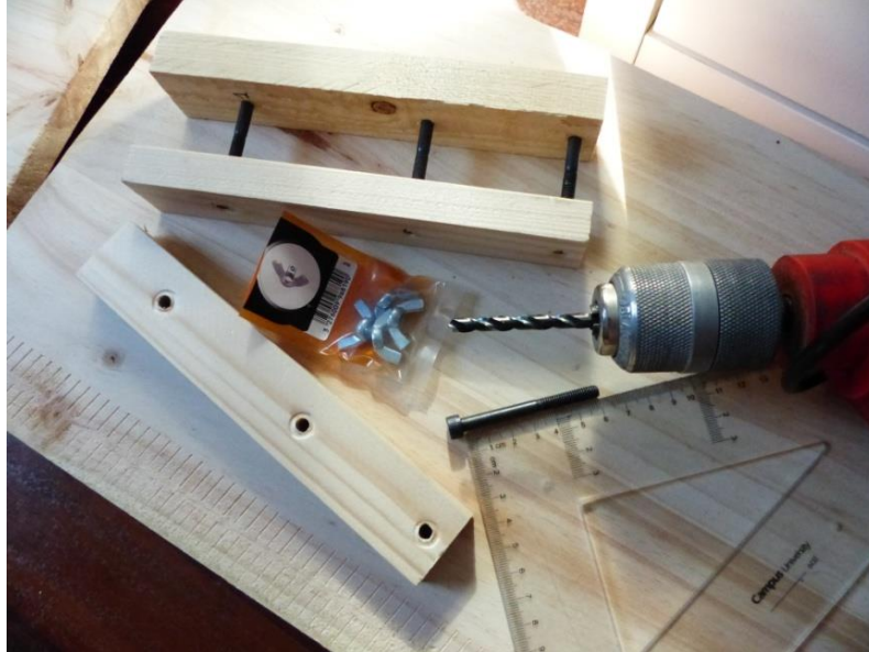
Ilustración 20- Preparación de las piezas de unión de las dos partes de la base
