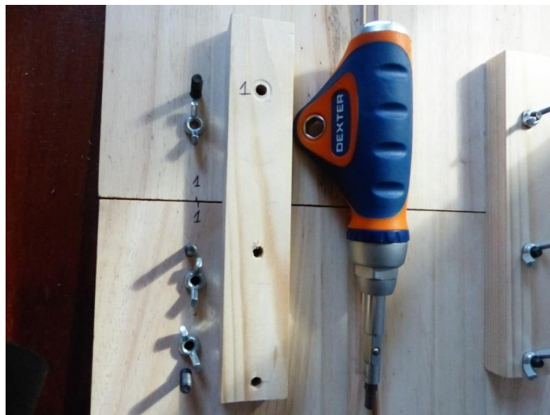
Ilustración 19- Unión de las dos piezas de la base con tornillos y palomillas
