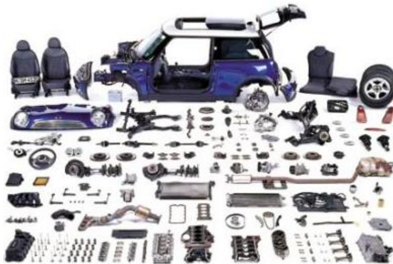
Figura 11.- Despiece de un vehículo convencional.
