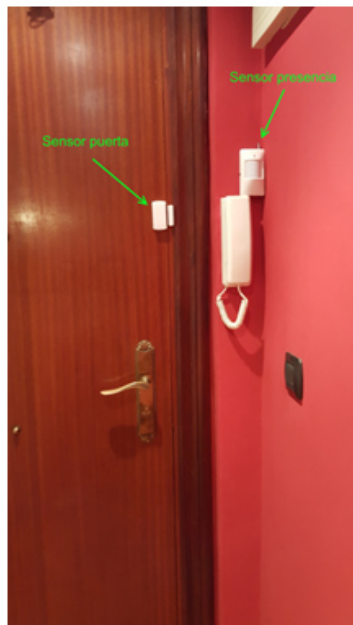
Figura 5.1 Configuración de sensores en la entrada de la vivienda
