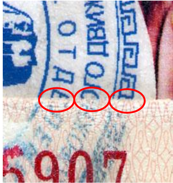
Fotografía n° 7 y 8: Mostrando con mayor detalle los límites de la fotografía. Se puede observar cómo el texto que figura en el sello se interrumpe de forma artificial.
