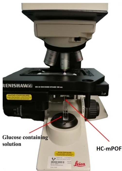
Irudia 8-28. NH-PZOm zuntza erabiliz Raman neurketak gauzatzeko muntaia esperimentalak.
