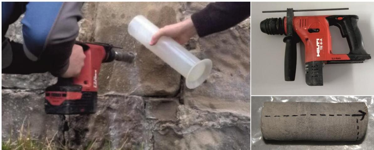
Fig. 15 – Toma de muestras de roca del muro de mampostería de las Galerías Punta Begoña con una taladradora HILTI TE 6-A equipada con una broca de 25 mm de diámetro interior.
