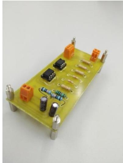
**Figura 4.12: Filtro KRC pasa baja diseñado e implementado con etapa diferencial.**
