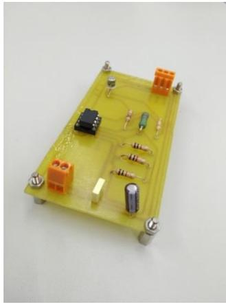
**Figura 4.8: Placa con oscilador compuesto por timer 555, que proporciona pulsos de control.**
