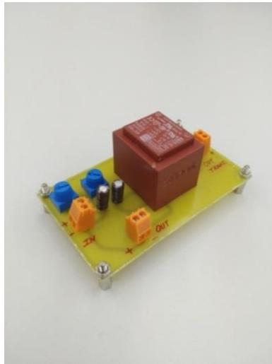
Figura 4.14: Filtro *KRC* pasa baja diseñado e implementado con transformador y potenciómetros.
